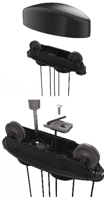
9. Entfernen Sie seitenweise die Schrauben, mit denen die Klemme befestigt ist, und entfernen Sie die Klemme.
