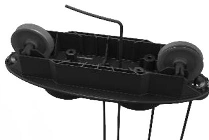
8. Haz un nudo simple a unos 55-75 mm (2-3 in) del extremo de la cuerda. Usa el orificio opuesto como guía para calcular la longitud necesaria.
