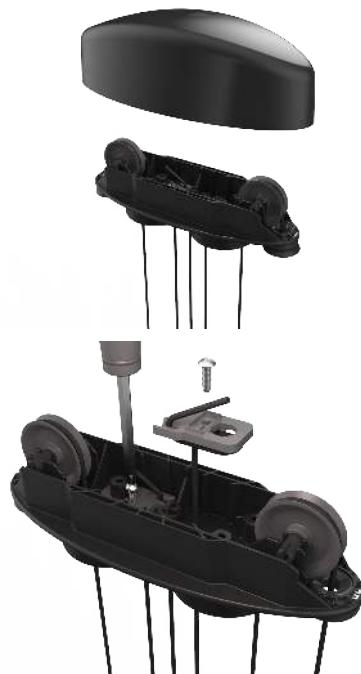
9. Quita los tornillos utilizados para sujetar la abrazadera y retira la pinza primero en un lado y después en otro.
