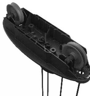
13. Vuelve a colocar la tapa superior con los cuatro tornillos.
