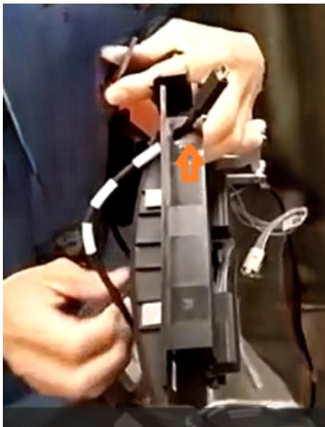
2. Tirez le câble vers le haut jusqu'à ce que le raccord atteigne le trou. Poussez ensuite le raccord vers le haut jusqu'à ce qu'il soit entièrement installé dans le trou.
