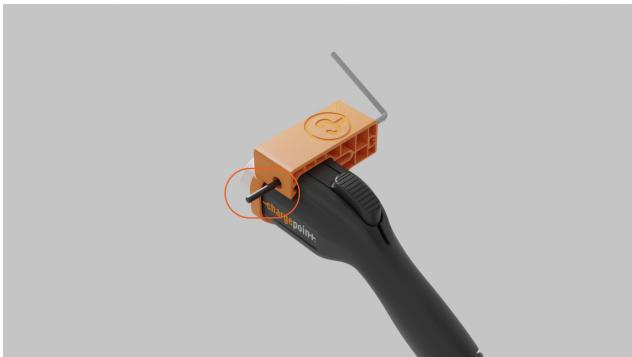
4. Serrez le boulon d'extraction jusqu'à ce que la goupille de loquet ait émergé complètement du trou de sortie. Retirez-la manuellement.
