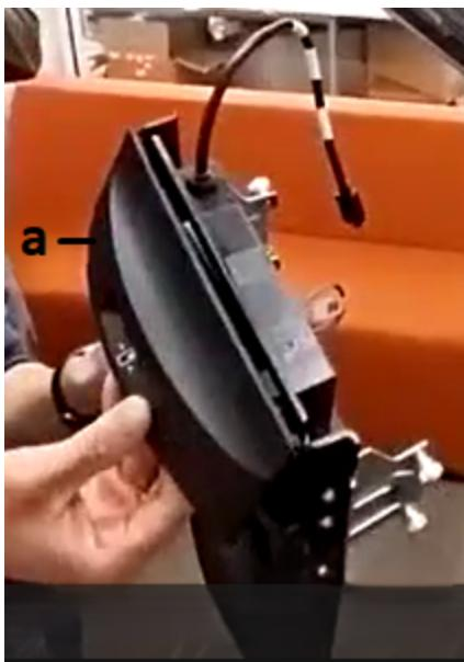
2. Retirez le câble USB-C à travers le trou de raccordement pour retirer le module de lecteur de puce.
