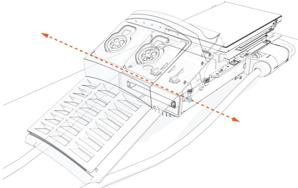
8. Positionnez le châssis du support sur la partie supérieure de la tête.
