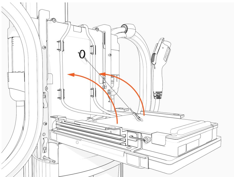
8. Serrez les vis à 1,7 Nm (15 in-lb) pour fixer le CCOM.
