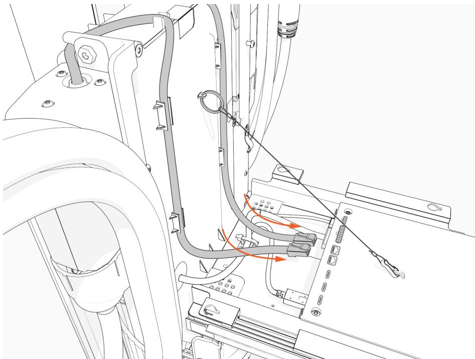
6. Faites glisser les câbles Ethernet RJ45 dans les fentes.
