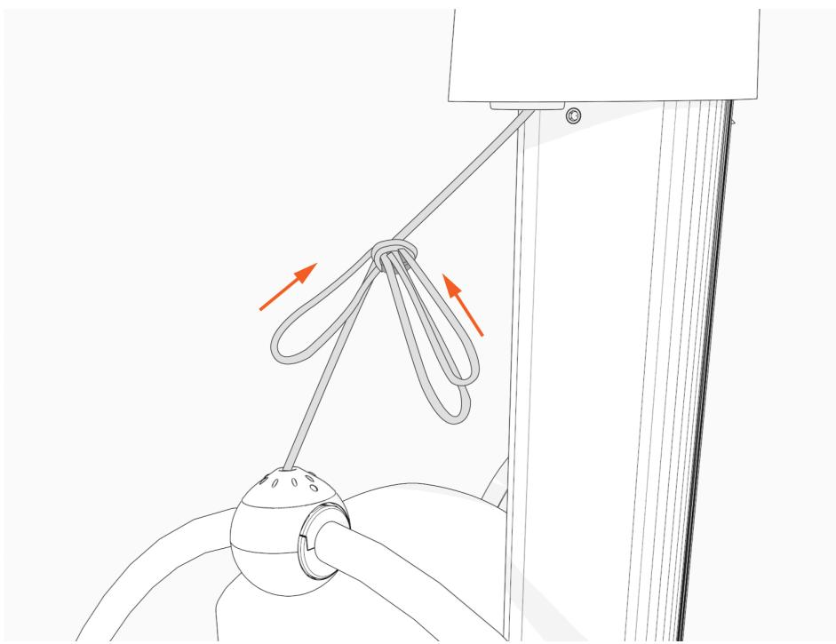
6. Vérifiez que le câble de recharge se déroule et se rétracte complètement et sans à-coups.
