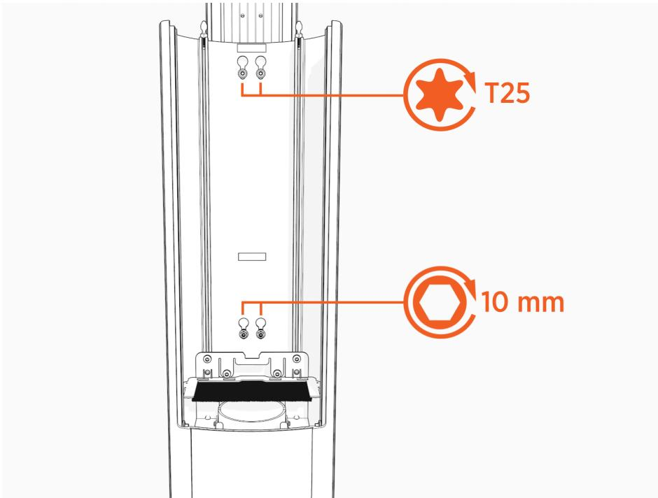
Lors de l'installation du nouveau KGC, serrez les vis supérieures T25 à 5,7 Nm (50 po-lb). Utilisez une clé de 10 mm pour serrer les écrous près du bas à 5,7 Nm (50 lb).
