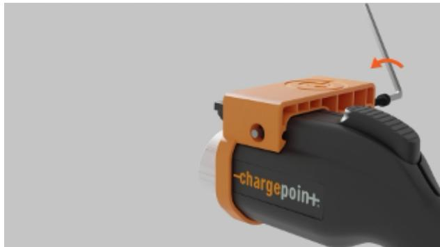
14. Serrez le boulon d'entraînement jusqu'à ce que la broche de guidage dépasse complètement du trou de sortie. Retirez la broche à la main.
