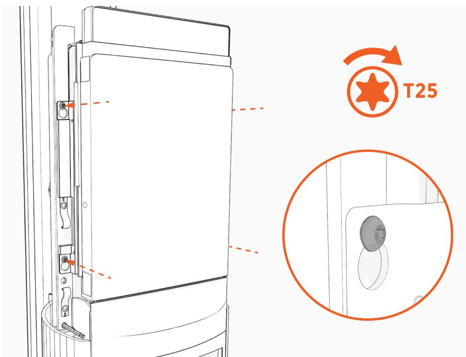
19. Soulevez la partie supérieure pour la retirer du socle ou du boîtier de support mural. Posez-la avec précaution sur une surface rembourrée.
