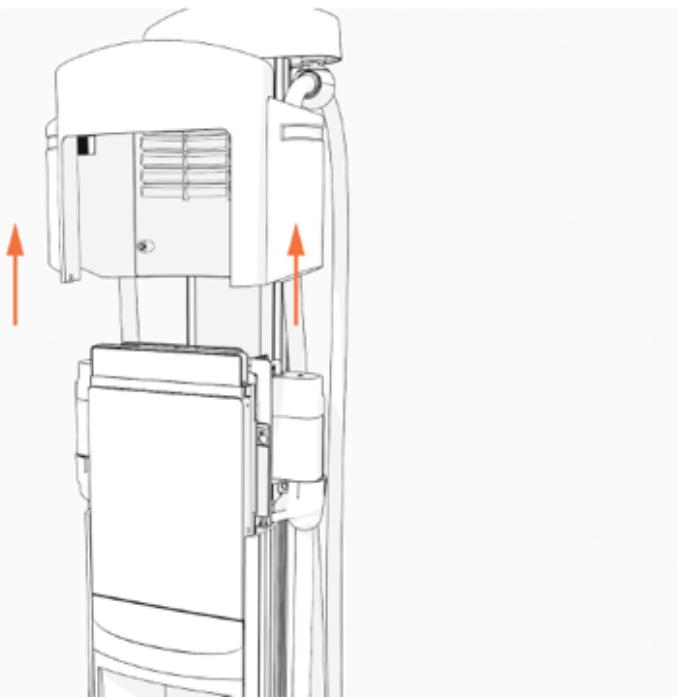
11. Utilisez la clé en L pour desserrer, sans les retirer, les vis fixant la partie supérieure.
