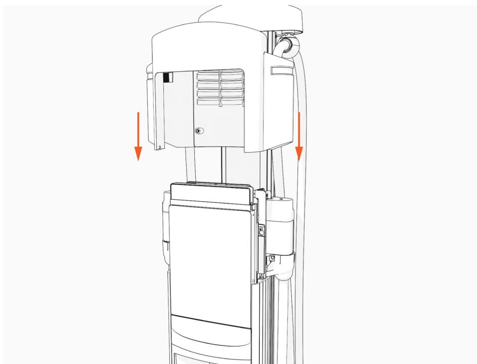
13. Serrez les deux vis captives à un couple de 1,1 Nm.
