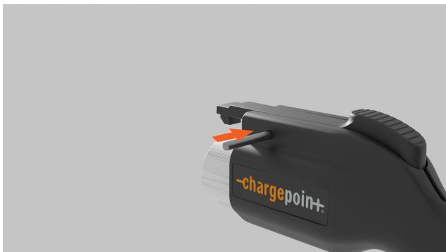
11. Utilisez la clé hexagonale pour desserrer le boulon d'entraînement. Insérez complètement la broche du loquet dans la fente.
