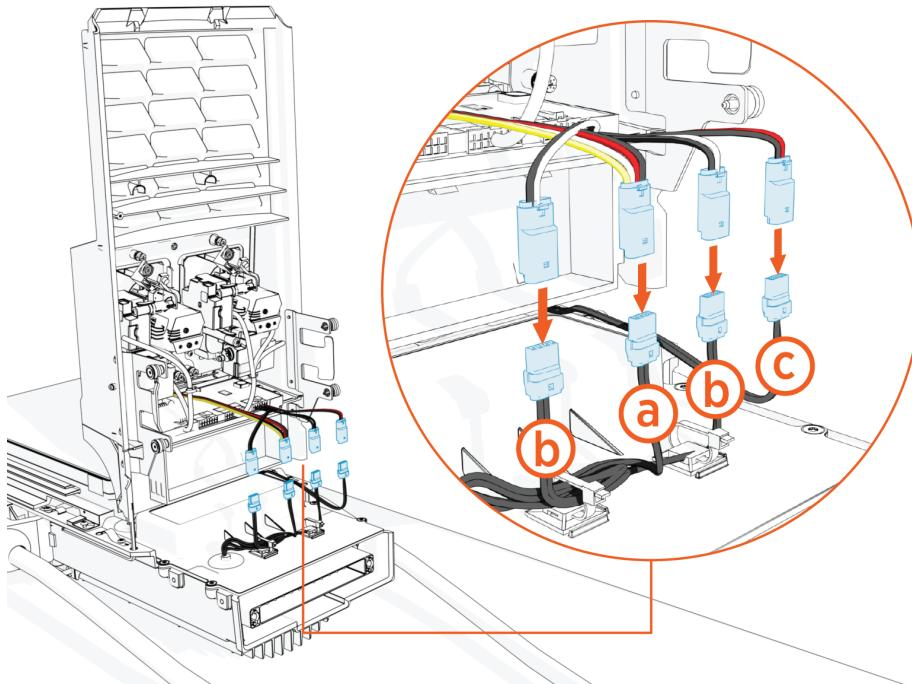
5. Retirez le châssis de l'Omni Port et mettez-le de côté.
