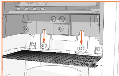
5. À l'aide d'un tournevis dynamométrique T25, serrez les vis à un couple de **5,7 Nm (50 po-lb)** pour fixer la plaque d'alimentation.
