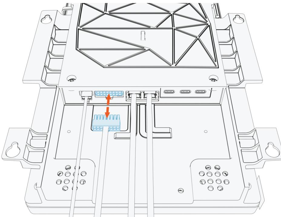
12. Branchez le connecteur mâle à 16 broches sur le côté femelle à 16 broches du câble CAN en Y.
