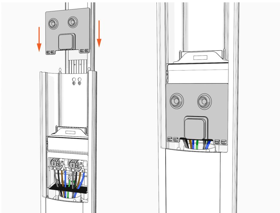
9. Alignez les rails de la partie supérieure avec le socle et faites-les glisser jusqu'à l'intérieur du boîtier du socle.
