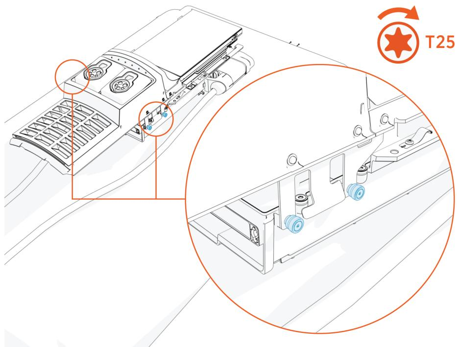
3. Éloignez le châssis du support de la partie supérieure pour accéder au câblage interne et aux composants du CCOM.
