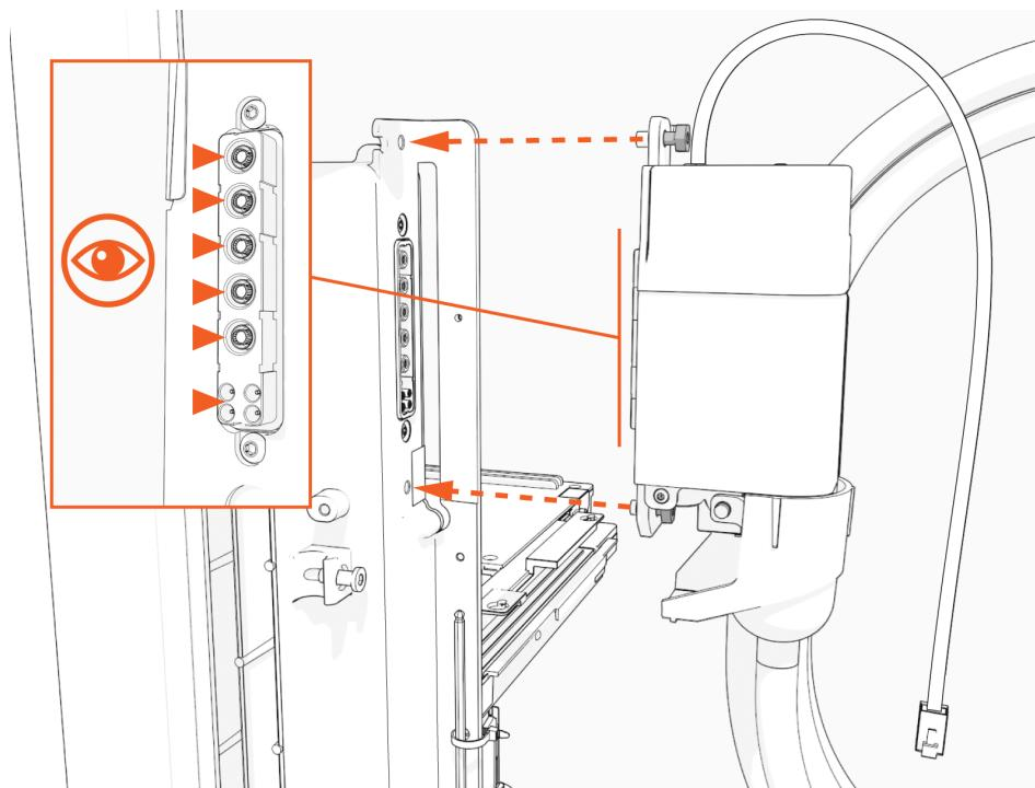
3. Sur les bornes à port simple, branchez le câble intelligent du côté **droit** en étant face à la borne de recharge. Branchez le connecteur vide sur le côté gauche.
