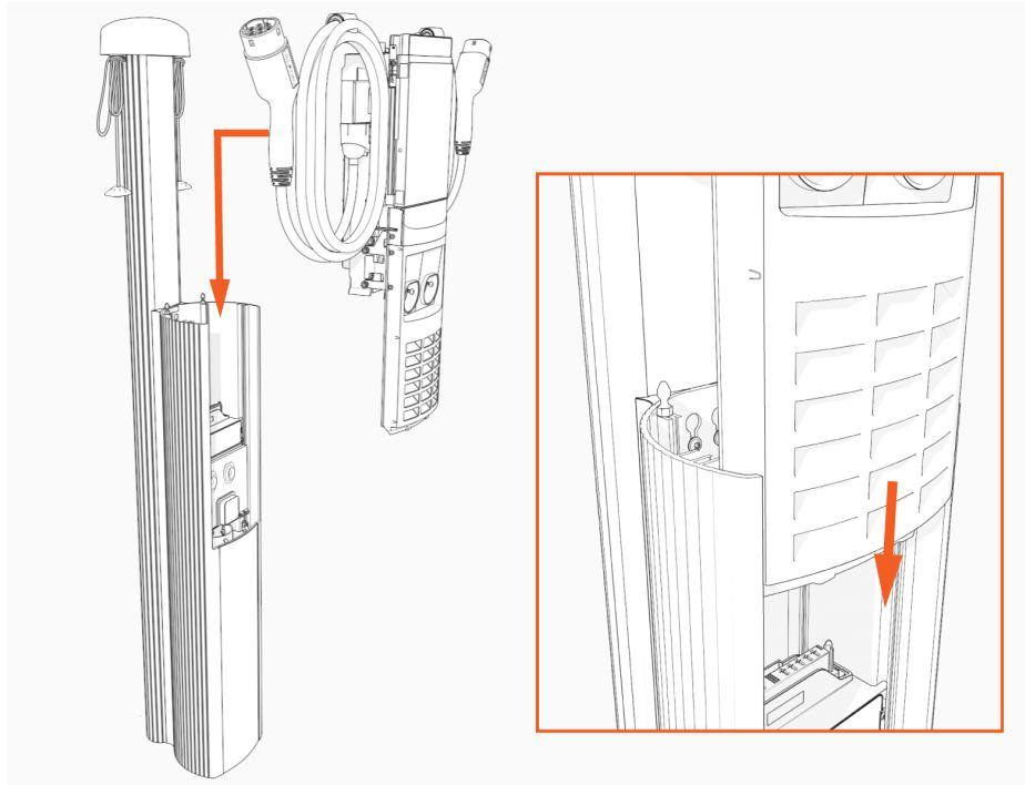
La partie supérieure repose sur la clé en L connectée sur le côté de l'ensemble.
