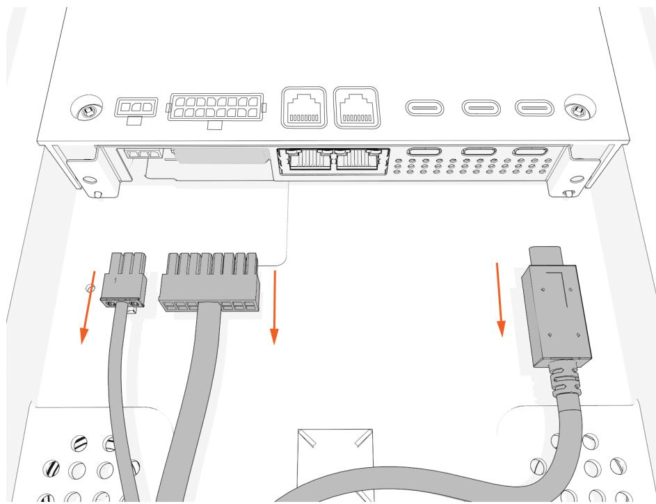
14. Détachez le crochet et l'attache, déposez le CCOM et mettez-le de côté.
