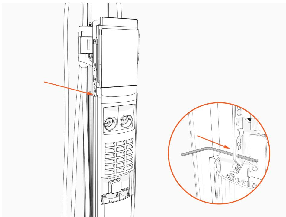
5. Desserrez les vis qui fixent le module de commande et de communication (CCOM) à la partie supérieure de la tête, sans les retirer.
