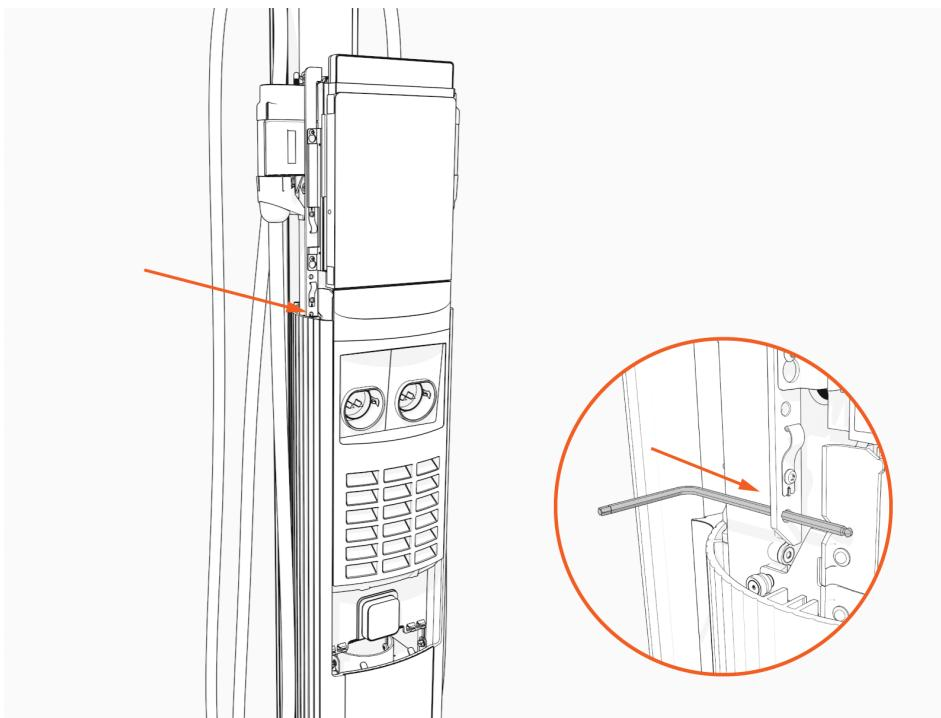
8. Avec un tournevis T25, dévissez sans les retirer les quatre vis M4 qui fixent l'unité de contrôle et de communication (CCOM) à la partie supérieure.
