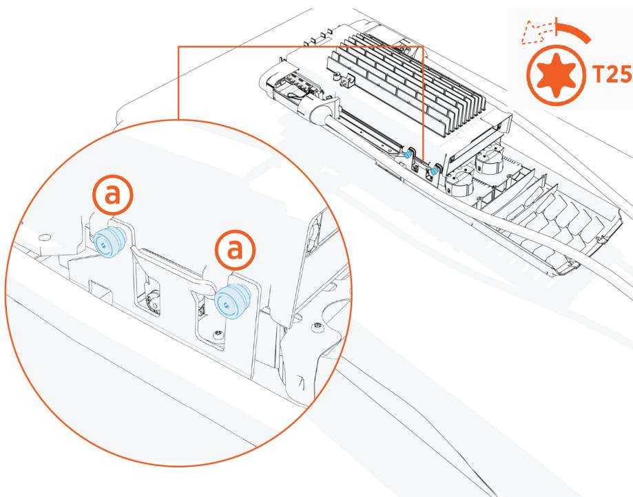
2. Soulevez les languettes et tirez le luminaire encastré **(a)** et les câbles du support **(b)** pour les déconnecter du cadre du support.
