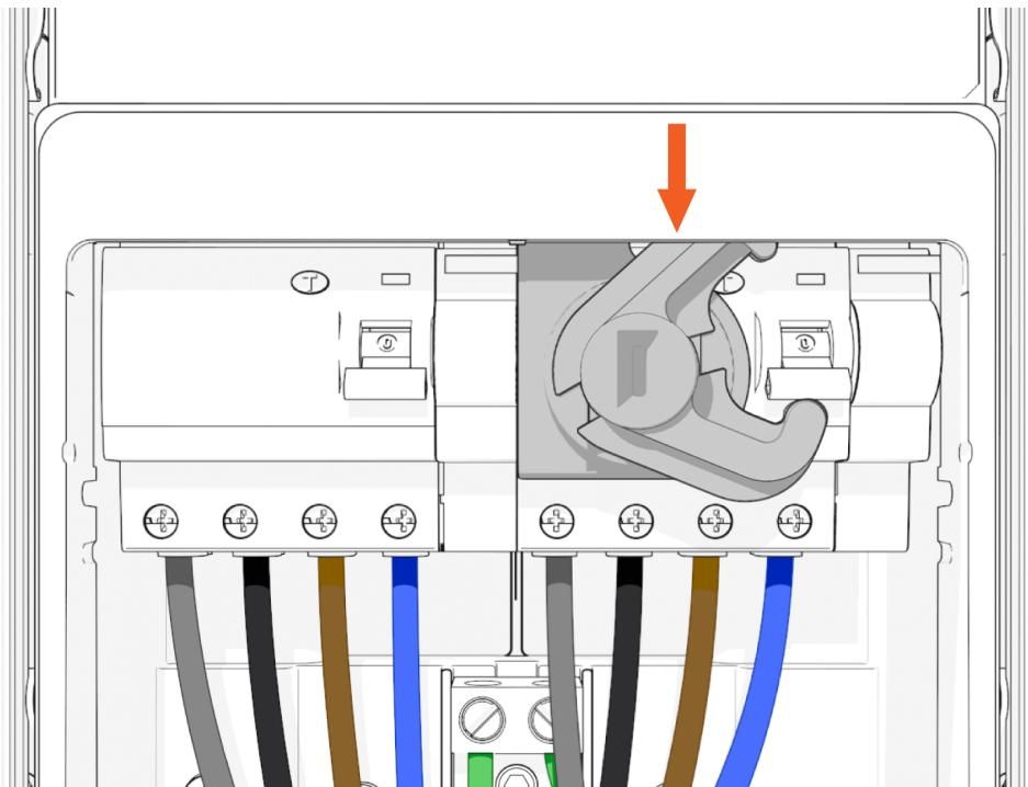
5. Répétez les étapes précédentes pour installer le second interrupteur de réinitialisation. Installez le second interrupteur sur les bornes à sortie simple et double.
