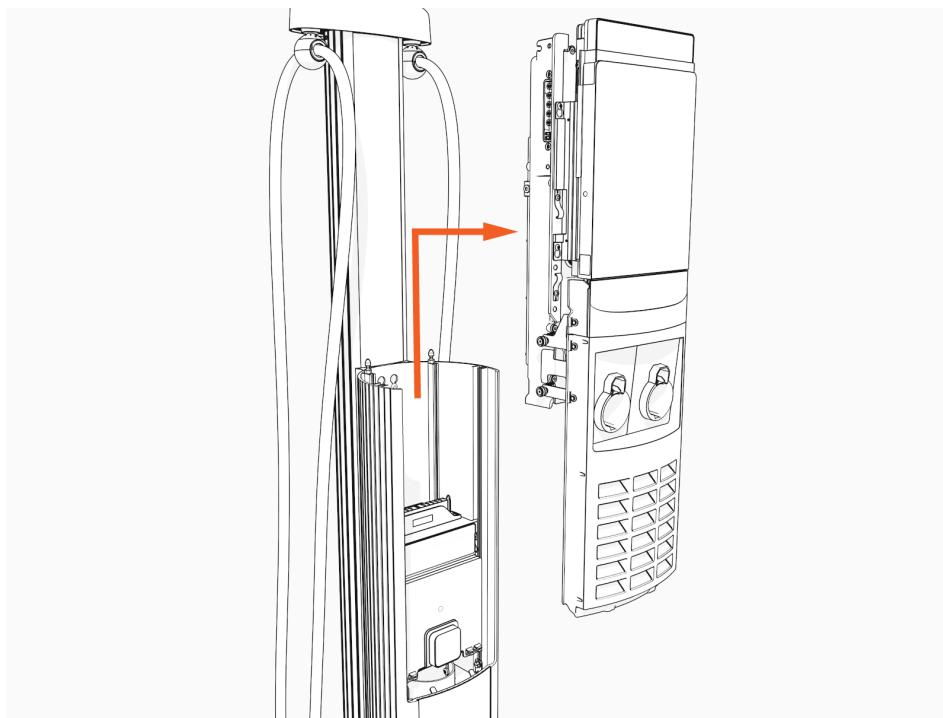
20. Orientez la partie supérieure de manière à ce qu'elle repose directement sur la surface rembourrée.
