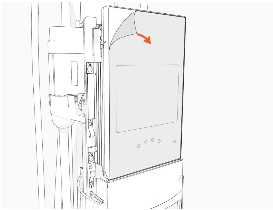
10. Enfichez les bords inférieur et supérieur de la lentille avant sur la partie supérieure.
