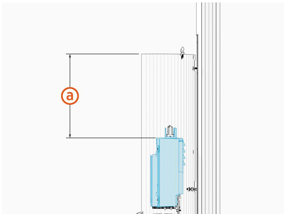
7. Reconnectez le câblage avant d'installer le couvercle de la plaque d'alimentation.
