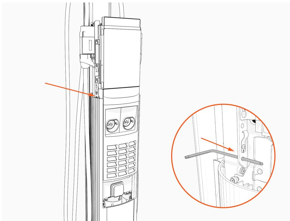
6. Utilisez la clé en L pour desserrer, sans les retirer, les vis fixant la partie supérieure.
