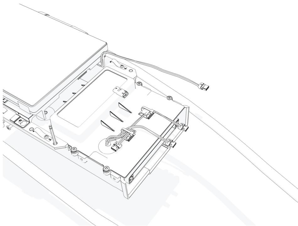
2. Positionnez le nouveau châssis du support Omni Port à un angle de 45° par rapport à la partie supérieure.
