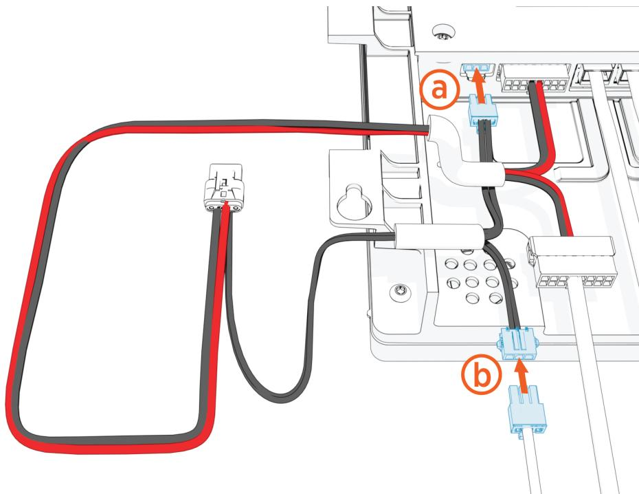
16. Assurez-vous que l'autre extrémité du câble CAN en Y est visible et accessible pour une connexion ultérieure à l'Omni Port.
