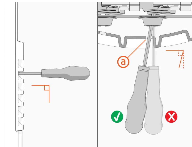
13. Utilisez le tournevis pour tourner l'activateur (c) dans le sens des aiguilles d'une montre afin d'éteindre l'interrupteur différentiel (d).
