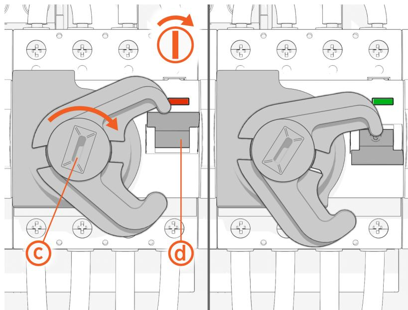
14. Utilisez le tournevis pour tourner l'activateur dans le sens inverse des aiguilles d'une montre afin de réactiver l'interrupteur différentiel. L'activateur passe par le bouton de test (e) durant ce processus.
