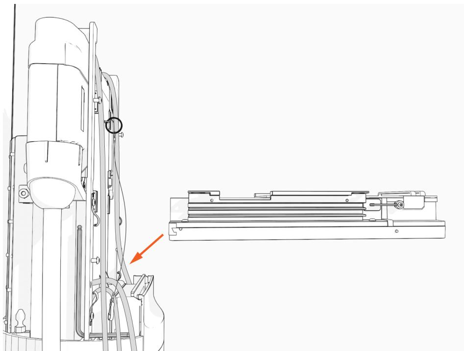
3. Installez le crochet et l'attache.
