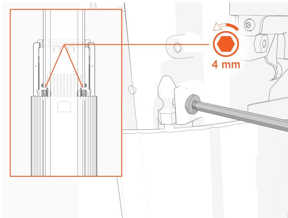
4. Soulevez la partie supérieure et insérez une clé en L ou un tournevis dans le trou sur le côté de la partie supérieure pour la maintenir en position relevée.
