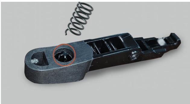
9. Alignez délicatement l'autre extrémité du ressort avec l'indentation circulaire du connecteur. Alignez les trous des broches du loquet et du connecteur.
