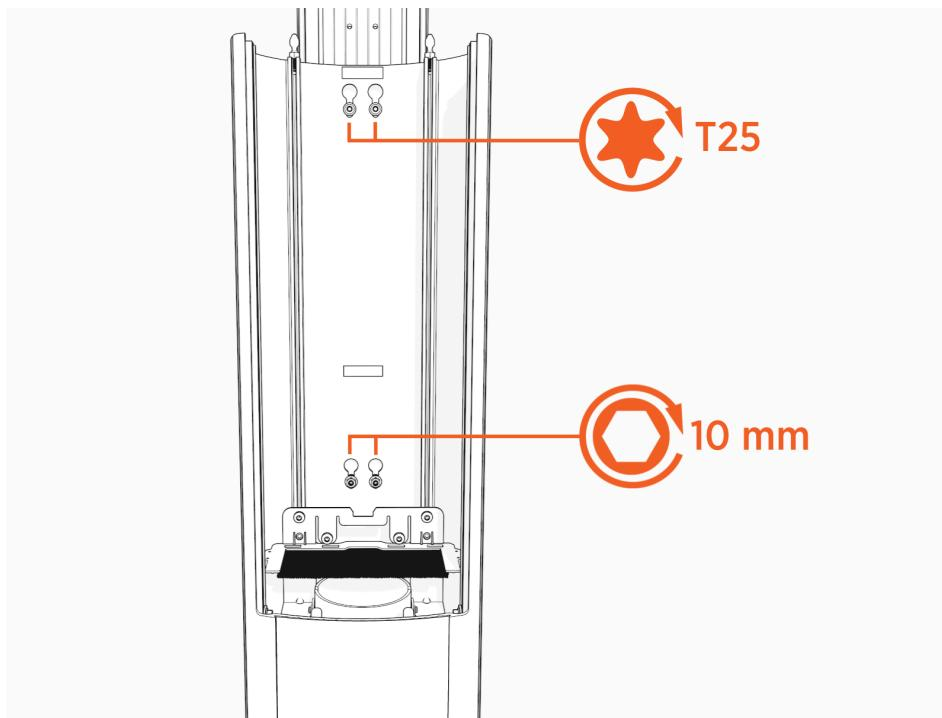
9. Réinstallez la partie supérieure et les câbles de recharge.
