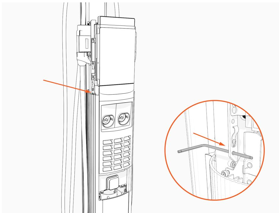
8. Débranchez les bords supérieur et inférieur de la lentille avant et placez-la avec précaution sur une surface rembourrée.
