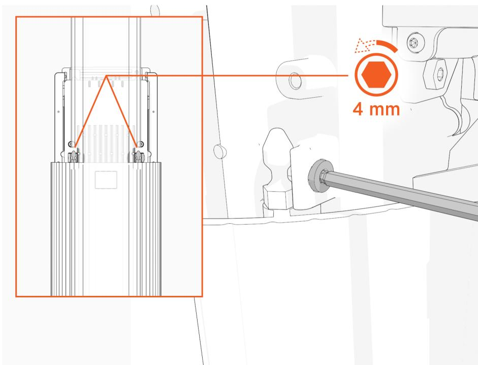
5. Soulevez la partie supérieure et insérez une clé en L ou un tournevis dans le trou sur le côté de la partie supérieure pour la maintenir en position relevée.
