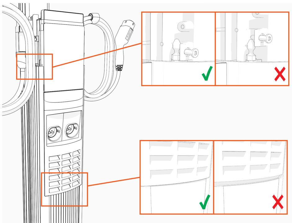
5. À l'aide de la clé en L ou du tournevis hexagonal 4 mm, serrez les deux vis.
