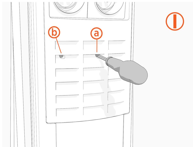
12. Insérez le tournevis (a) de biais pour accéder à l'interrupteur différentiel droit.
