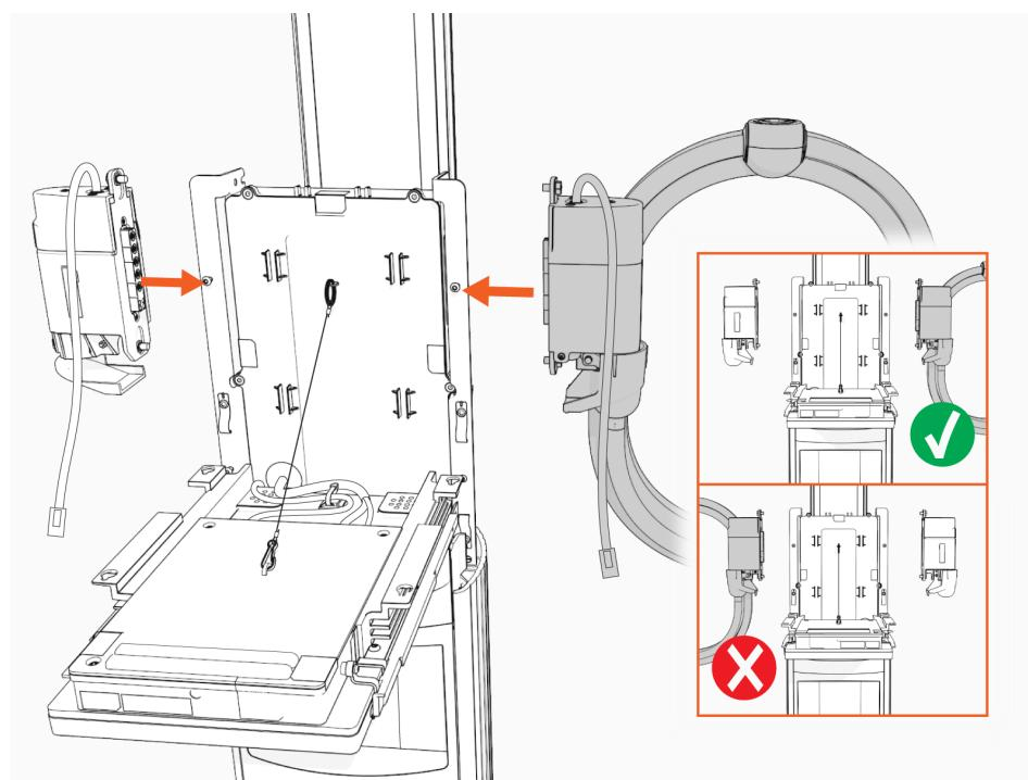
4. Serrez les vis supérieure et inférieure à 1,1 Nm (10 in-lb) pour fixer le câble intelligent.
