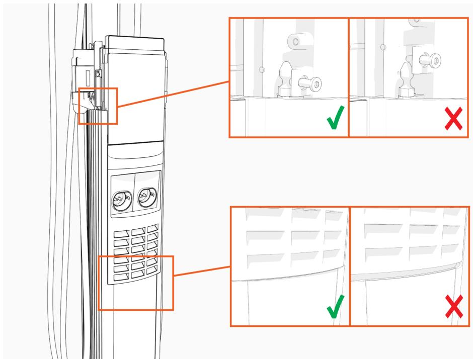
10. À l'aide de la clé en L ou du tournevis hexagonal 4 mm, serrez les deux vis.
