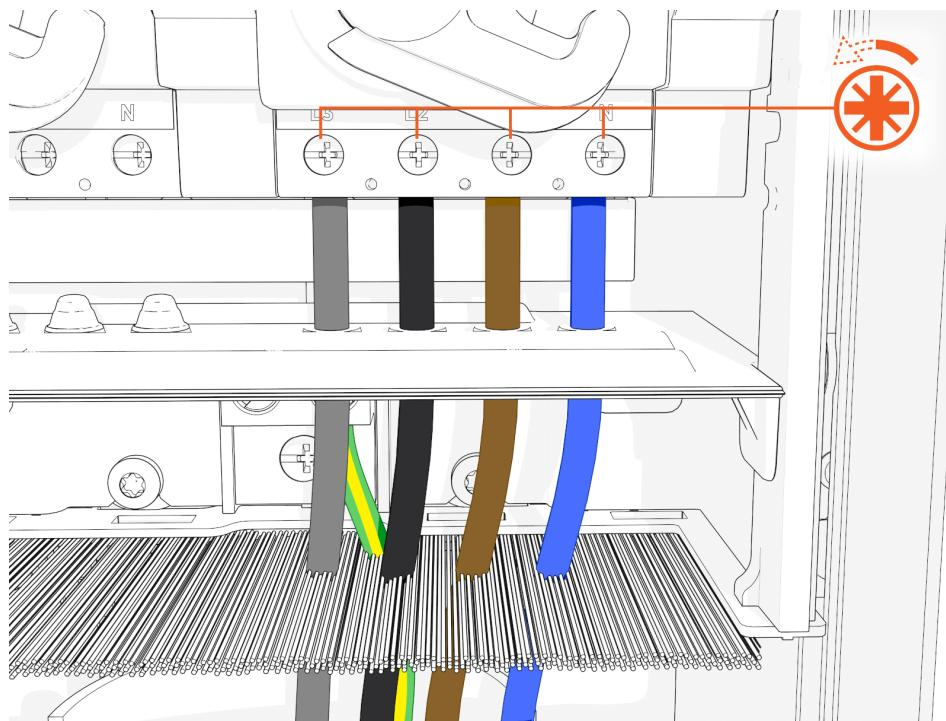
2. À l'aide d'un tournevis T25, desserrez les vis de la plaque d'alimentation sans les retirer.
