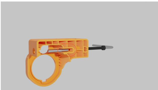
2. Insérez le connecteur J1772 dans l'outil de réparation et poussez-le en place jusqu'à ce que la broche du loquet soit alignée au milieu du trou de sortie.
