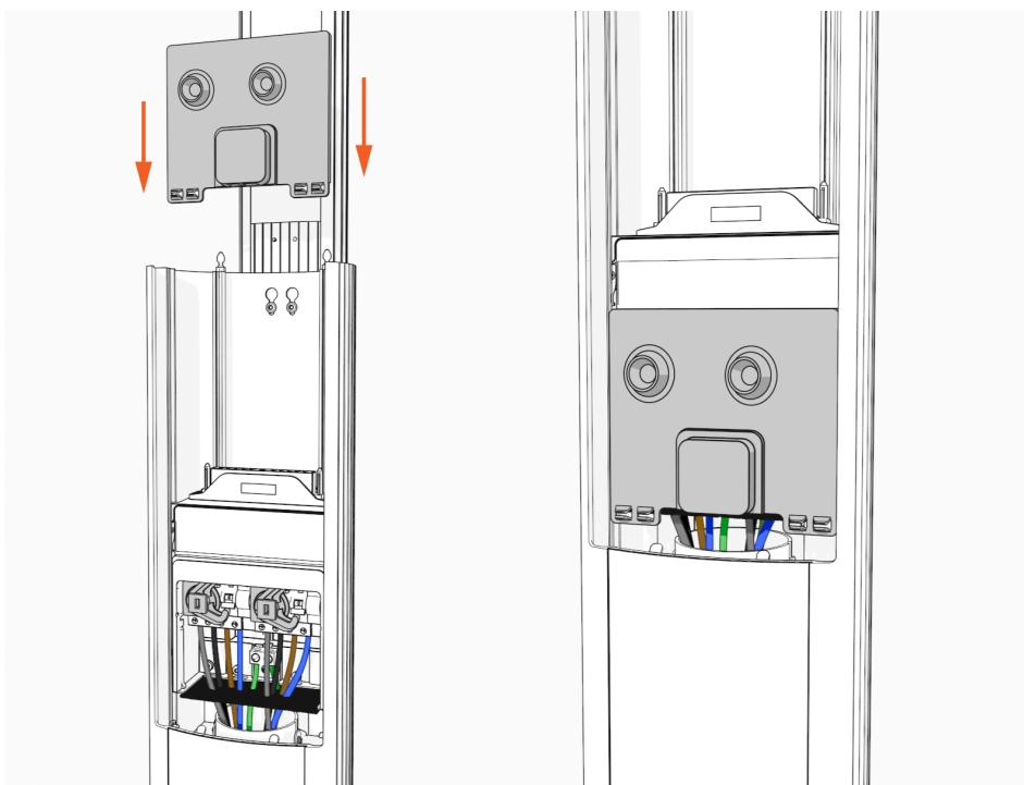
7. Alignez les rails de la partie supérieure sur le socle pour faire glisser la partie supérieure dans le boîtier du socle.
