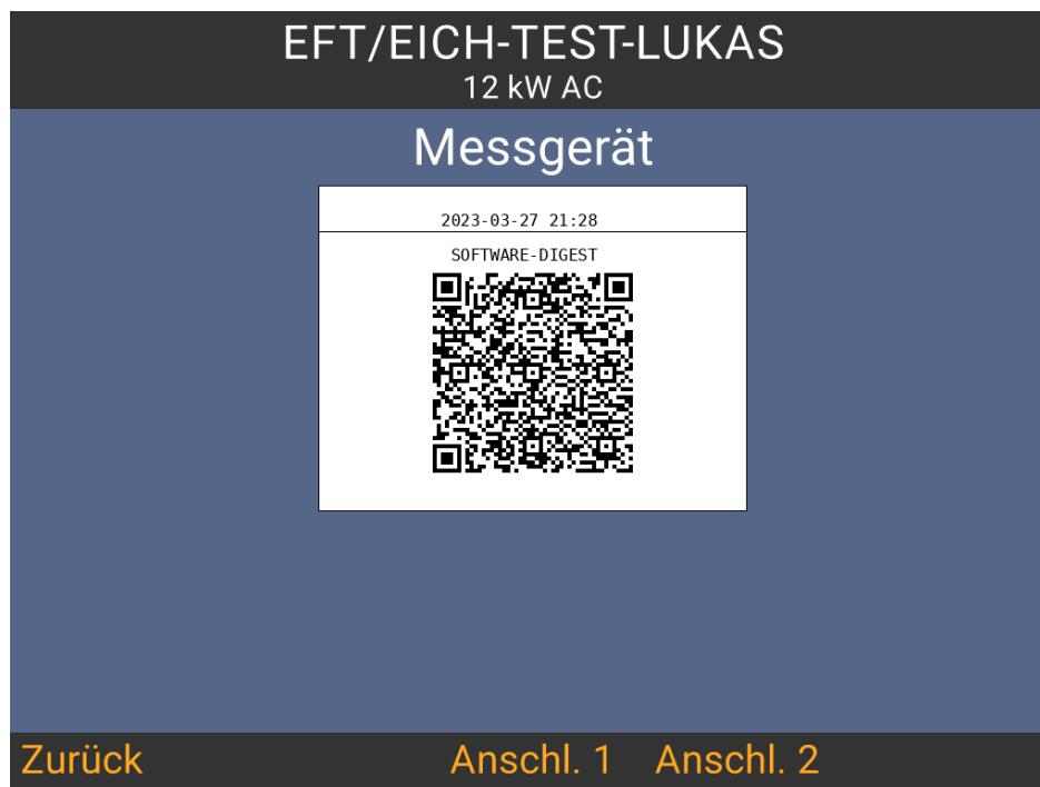
Die eichrechtlich relevanten Informationen befinden sich in der Mitte des umrahmten Feldes. Der Zeitstempel wird zuerst angezeigt, gefolgt vom QR-Code für die LRS-Version der Ladestation.
