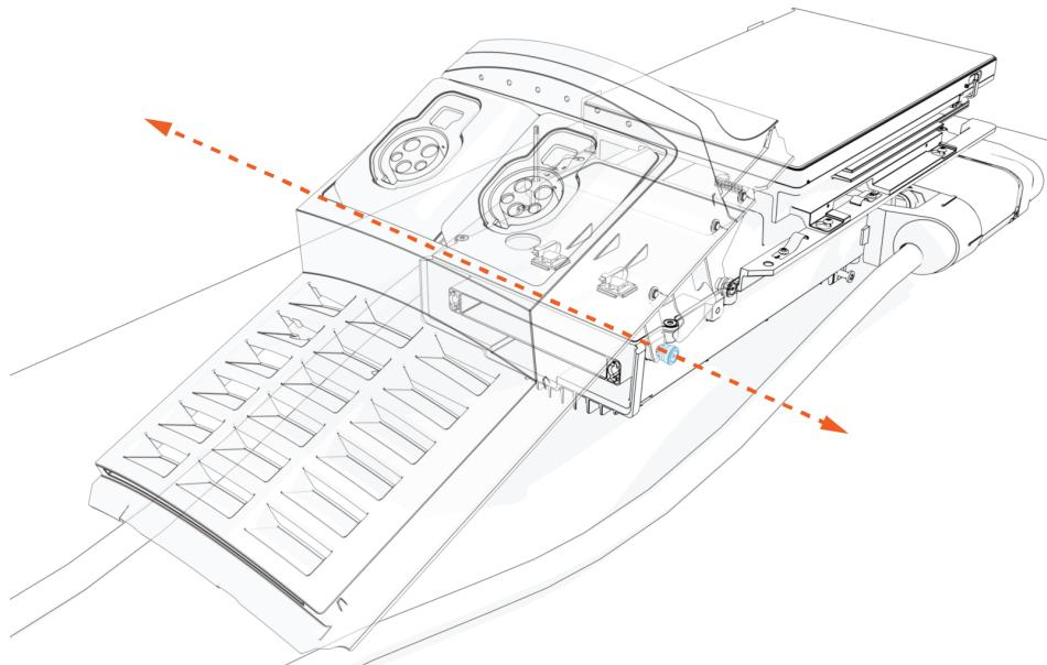
8. Positionieren Sie den Halterungsrahmen über der Kopfbaugruppe.
