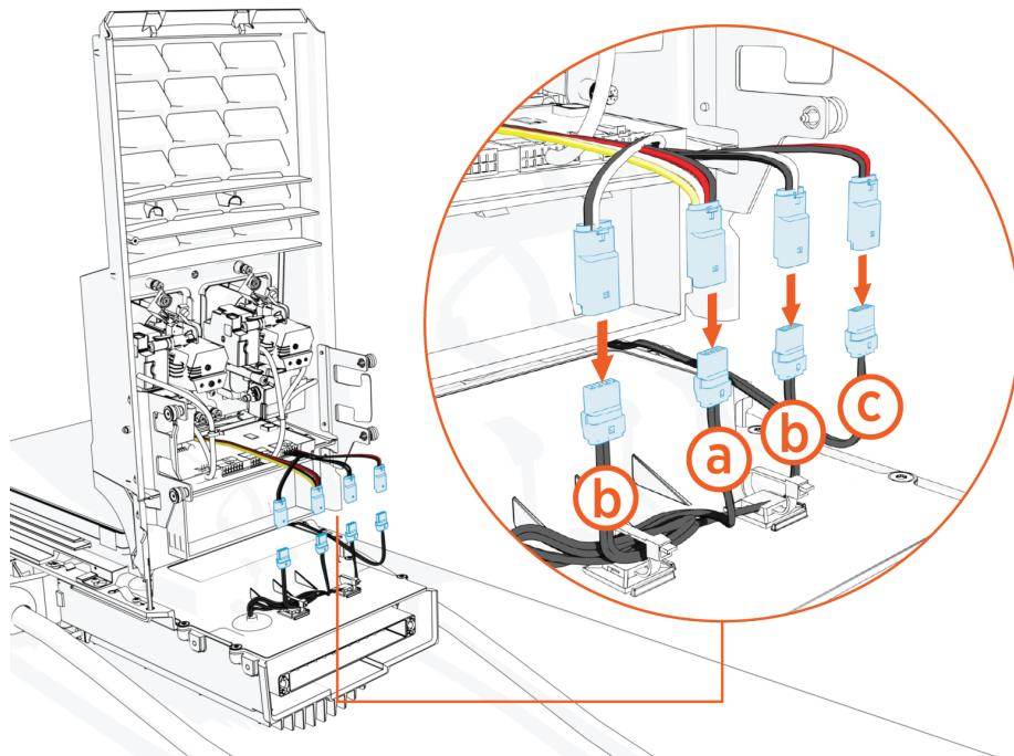
3. Stellen Sie sicher, dass die Verriegelung an jedem Kabel bündig ist.
