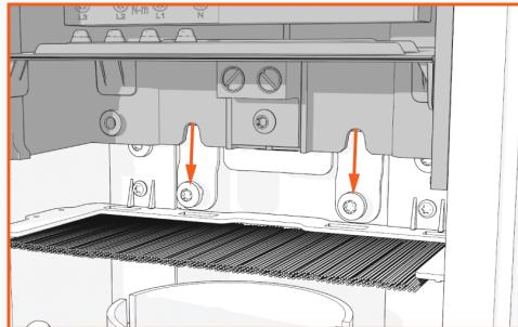
5. Ziehen Sie die Schrauben mit einem T25-Drehmomentschlüssel mit **5,7 Nm (50 Zoll/lbs)** an, um die Stromversorgungsplatte zu befestigen.
