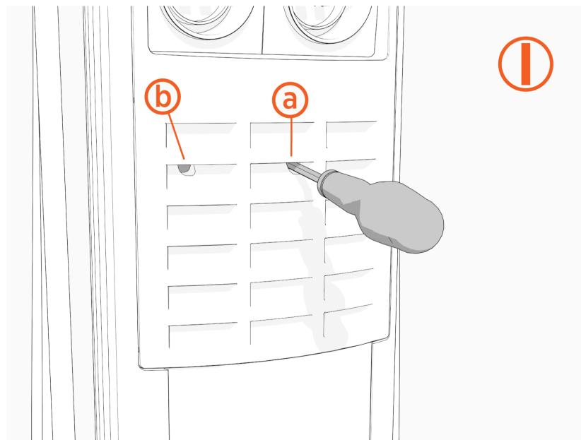
12. Führen Sie den Schraubendreher (a) schräg ein, um an den rechten FI-Schutzschalter zu gelangen.
