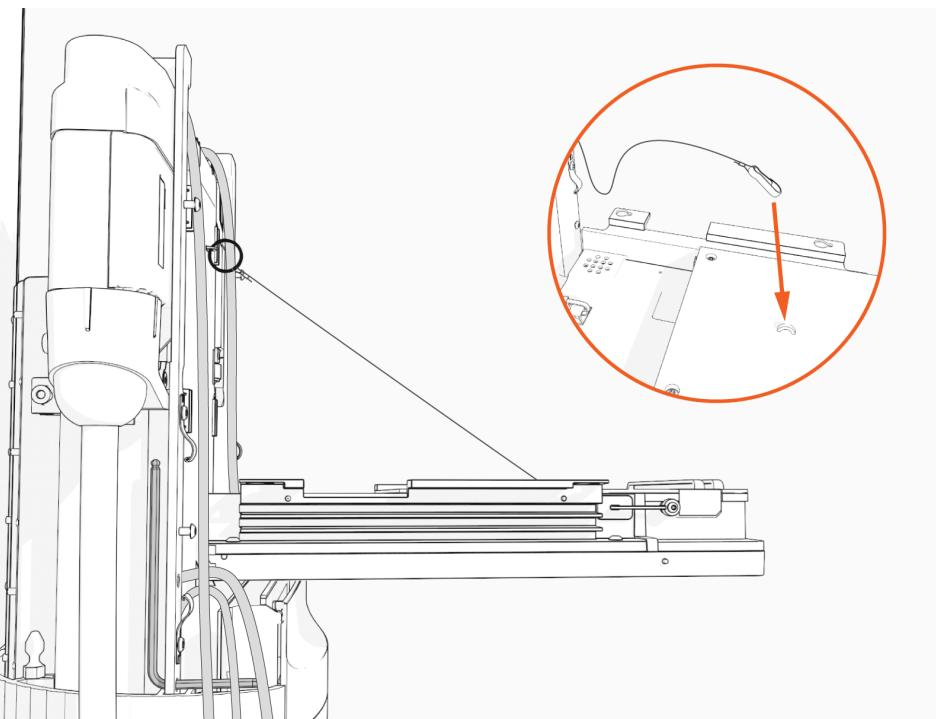
4. Verbinden Sie das Signal- und das Niederspannungskabel.
