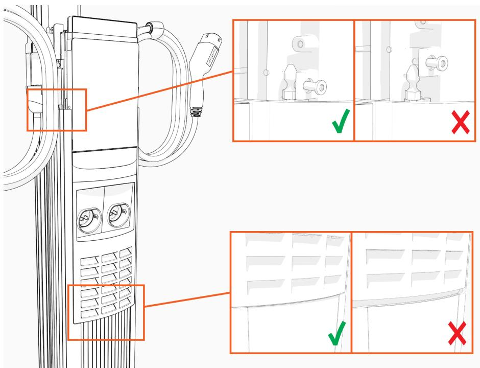
5. Ziehen Sie zwei Schrauben mit dem L-Schlüssel oder einem 4-mm-Inbusschlüssel fest.
