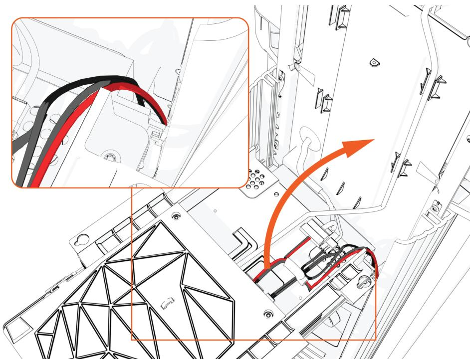
17. Heben Sie das CCOM an, und schieben Sie es auf der Kopfbaugruppe in Position.
