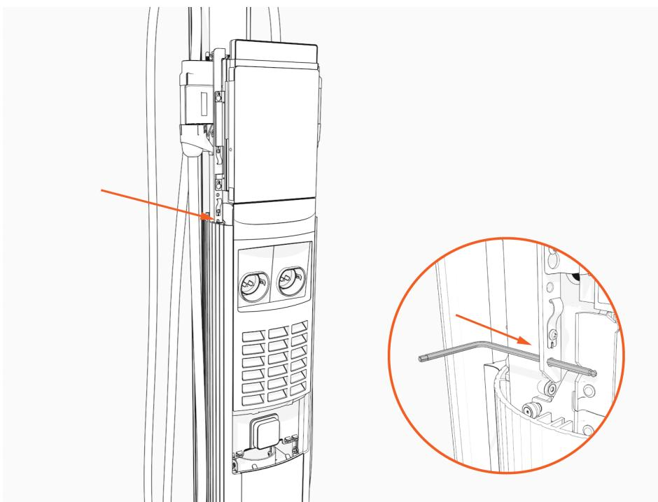
8. Stellen Sie sicher, dass alle Teile ausgerichtet sind, bevor die Kopfbaugruppe komplett abgesenkt wird.
