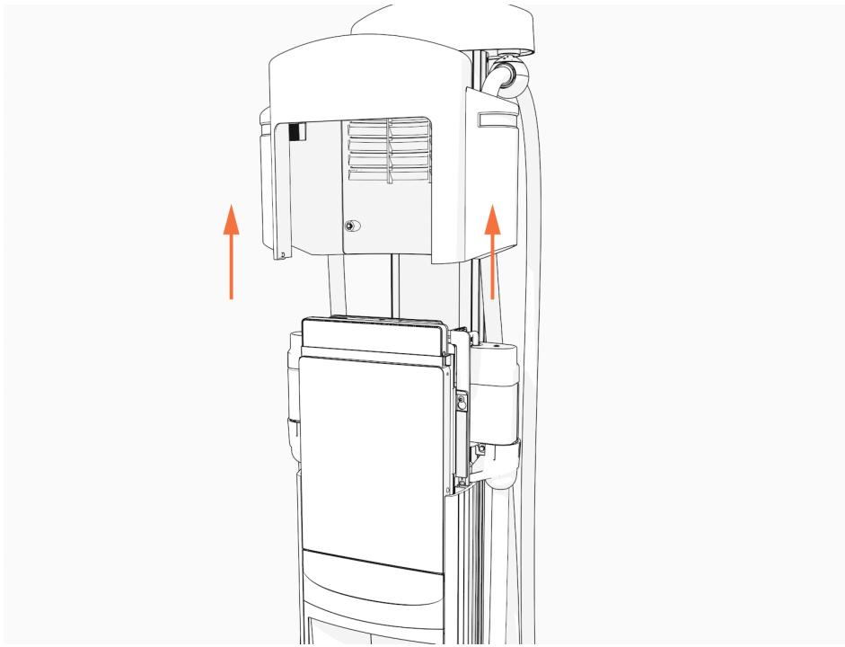
3. Verwenden Sie den L-Schlüssel, um die Schrauben zur Befestigung der Kopfbaugruppe zu lockern, aber nicht zu entfernen.
