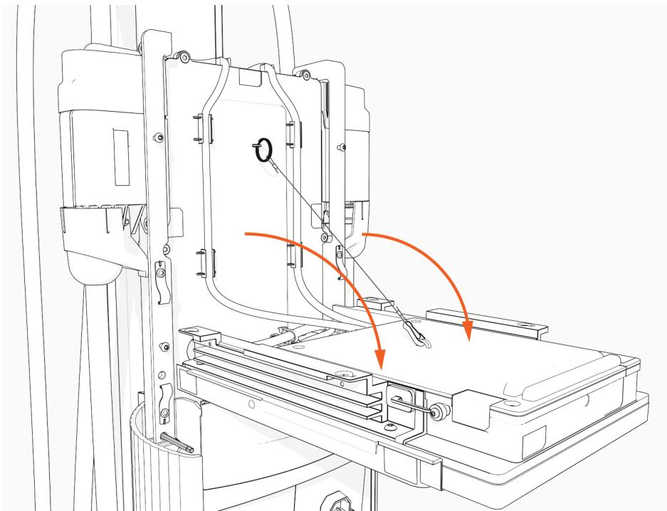
10. Lösen Sie die RJ45-Ethernet-Kabel.
