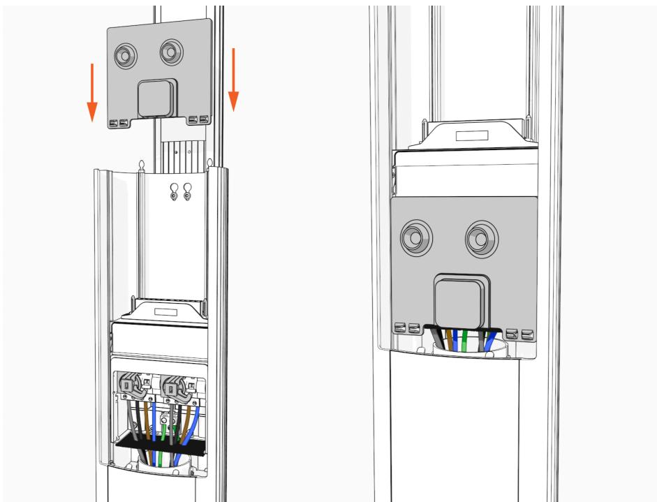
9. Richten Sie die Schienen an der Kopfbaugruppe am Sockel aus und schieben Sie sie vollständig in das Sockelgehäuse.
