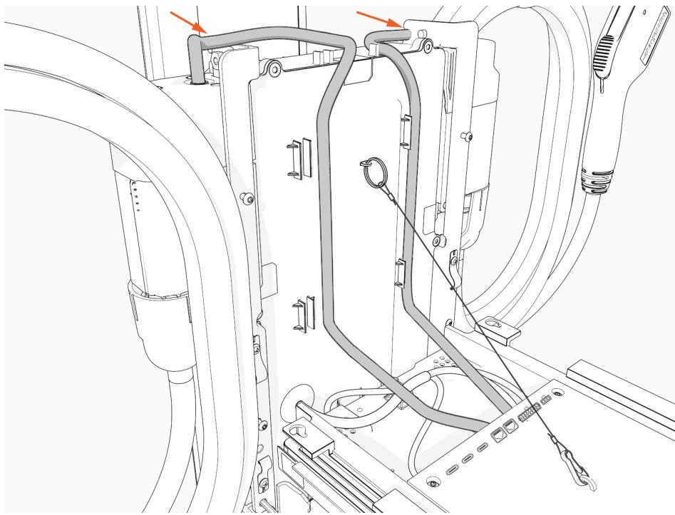
7. Heben Sie das CCOM an, und schieben Sie es auf der Kopfbaugruppe in Position.
