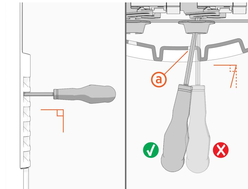
13. Drehen Sie den Aktivator (c) mit dem Schraubendreher im Uhrzeigersinn, um den FI-Schutzschalter (d) auszuschalten.
