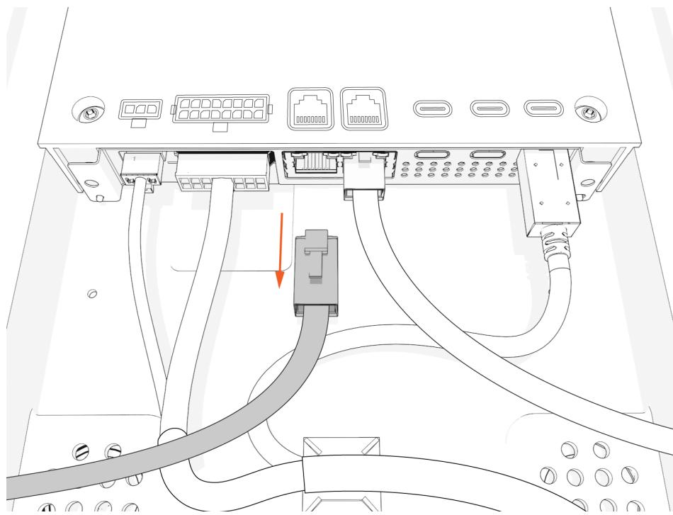
12. Lösen Sie die oberen und unteren Schrauben, die das intelligente Kabel sichern, gleichzeitig, um eine Beschädigung der Pins im intelligenten Kabel zu vermeiden.
