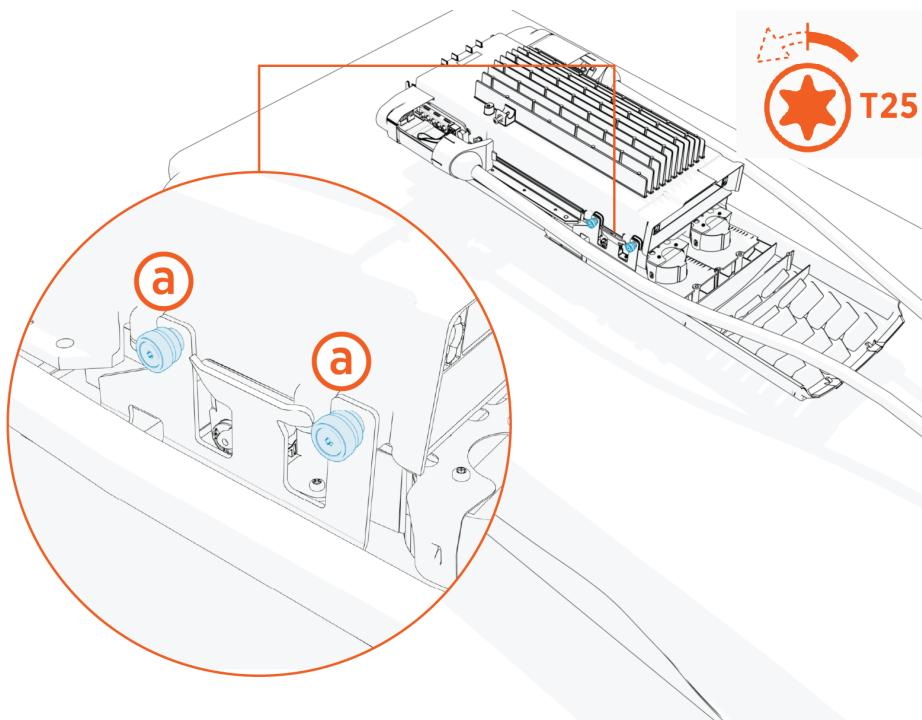
2. Heben Sie die Laschen an und ziehen Sie die Downlight- **(a)** und die Halterungskabel **(b)** heraus, um sie vom Halterungsrahmen zu trennen.
