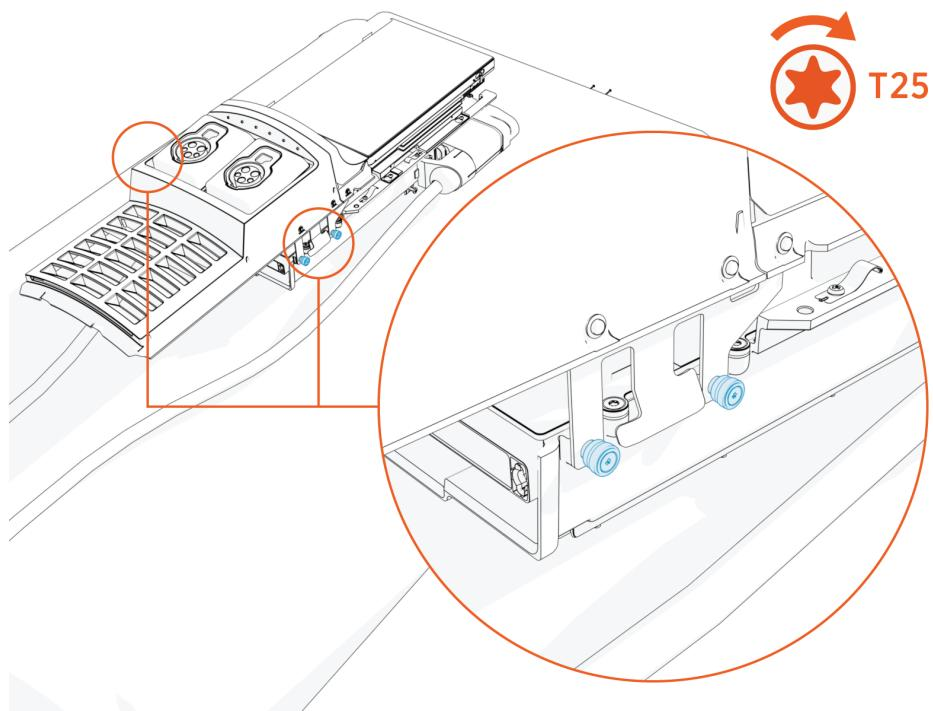
3. Klappen Sie den Halterungsrahmen von der Kopfbaugruppe weg, um Zugang zu den internen Kabeln und Komponenten des CCOM zu erhalten.
