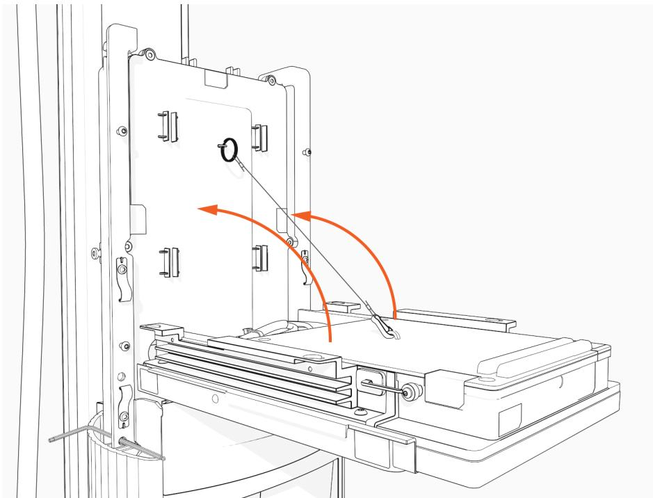
18. Ziehen Sie die Schrauben an, um das CCOM zu befestigen.
