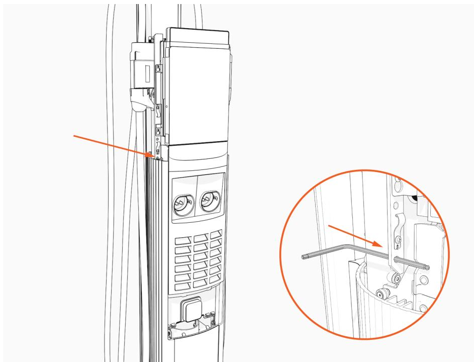
5. Lösen Sie die Schrauben, mit denen das Steuerungs- und Kommunikationsmodul (Control and Communication Module, CCOM) an der Kopfbaugruppe befestigt ist, aber entfernen Sie sie nicht.
