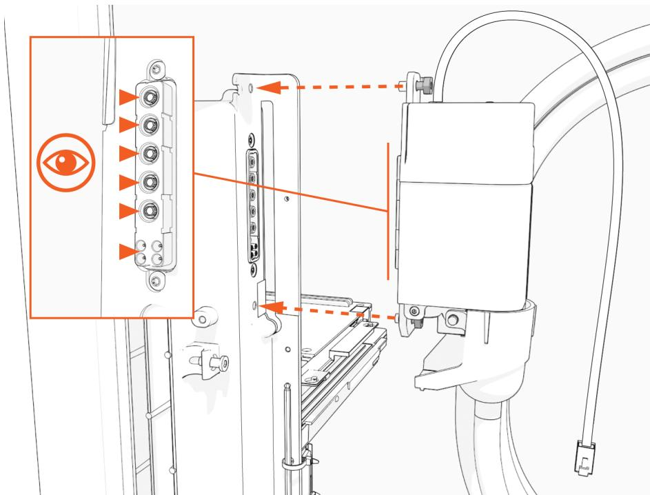
3. Befestigen Sie das intelligente Kabel bei 1-Port-Ladestationen an der **rechten** Seite, mit Blick in Richtung Ladestation. Schließen Sie den Blindstecker an die linke Seite an.
