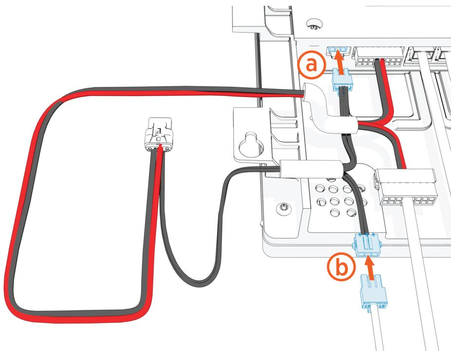
16. Stellen Sie sicher, dass das andere Ende des Y-Split-CAN-Kabels sichtbar und zugänglich ist, um es später an die Omni Port-Baugruppe anschließen zu können.
