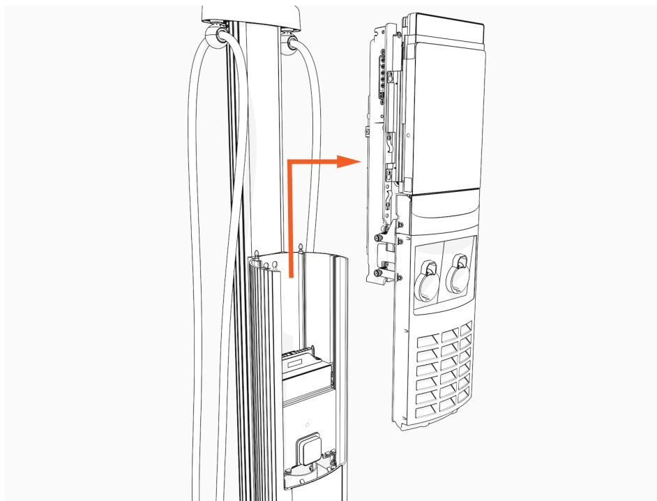
20. Richten Sie die Kopfbaugruppe so aus, dass der Bildschirm direkt auf der gepolsterten Unterlage aufliegt.
