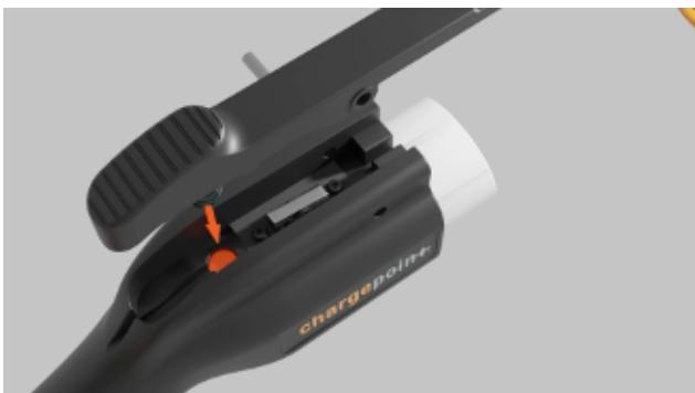
10. Setzen Sie den Führungsstift in die Verriegelung ein, um die Teile zusammenzuhalten. Drücken Sie die Verriegelung zusammen, um sicherzustellen, dass die Feder korrekt funktioniert.
