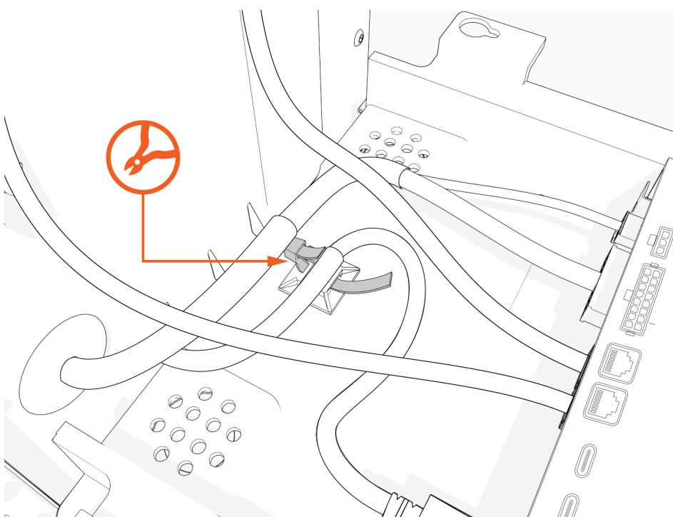
13. Trennen Sie die AC-Niederspannungs- und USB-C-Kabel.
