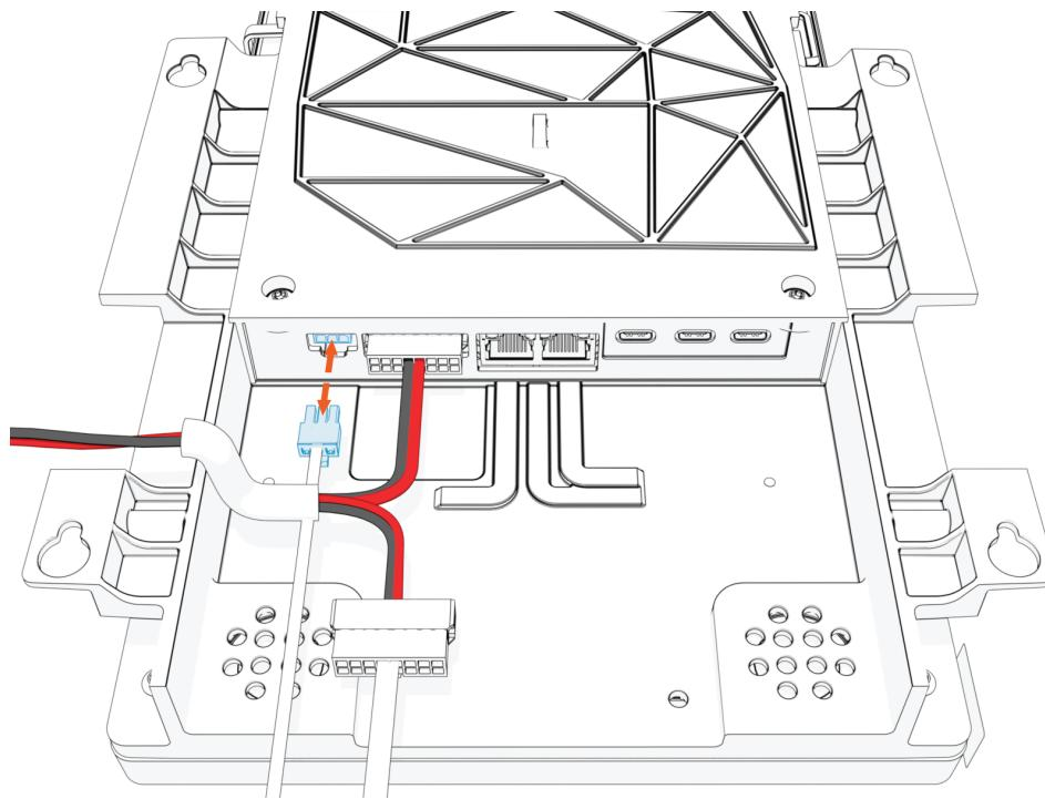
15. Stecken Sie den dreipoligen Leistungsstecker am Y-Split-Kabel (a) in das CCOM.
