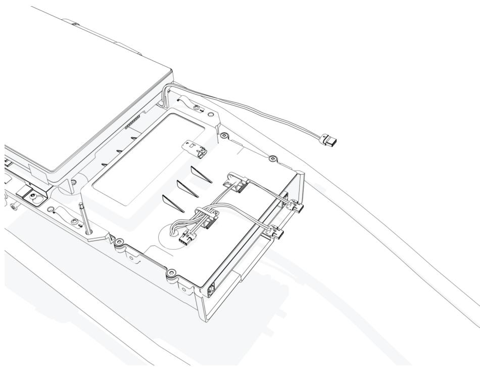
2. Positionieren Sie den neuen Omni Port-Halterungsrahmen in einem Winkel von 45° zur Kopfbaugruppe.
