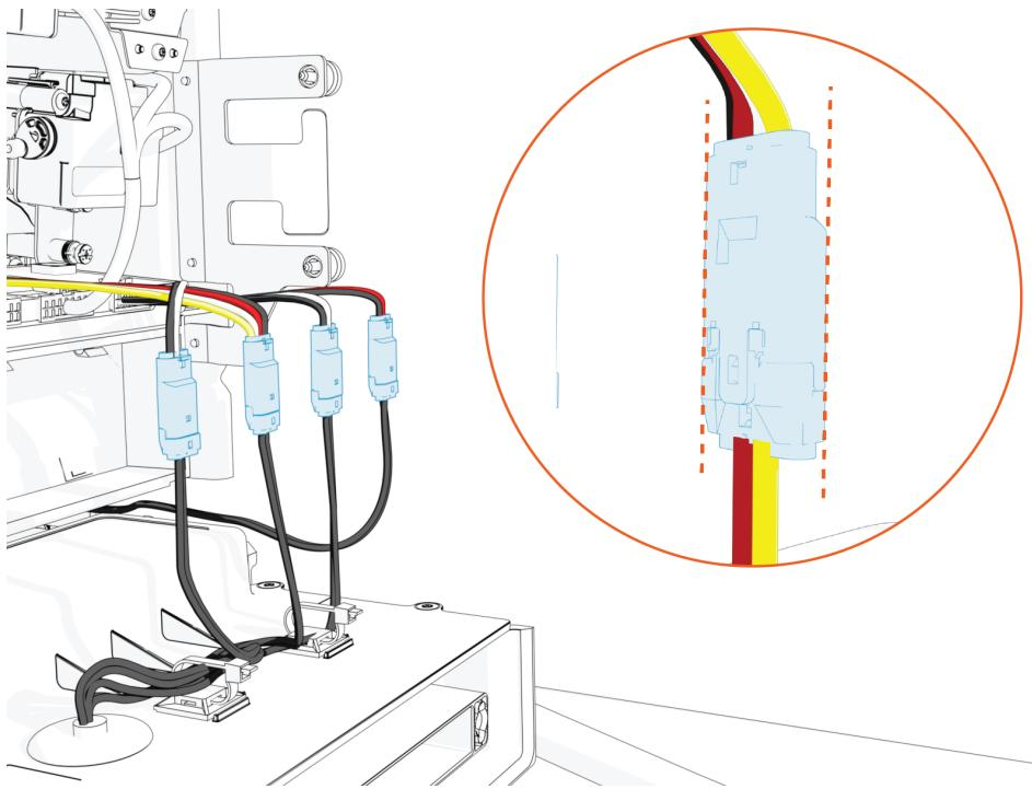
4. Verlegen Sie den Omni Port-Kabelstrang entlang der rechten Seite des Zählerfensters.
