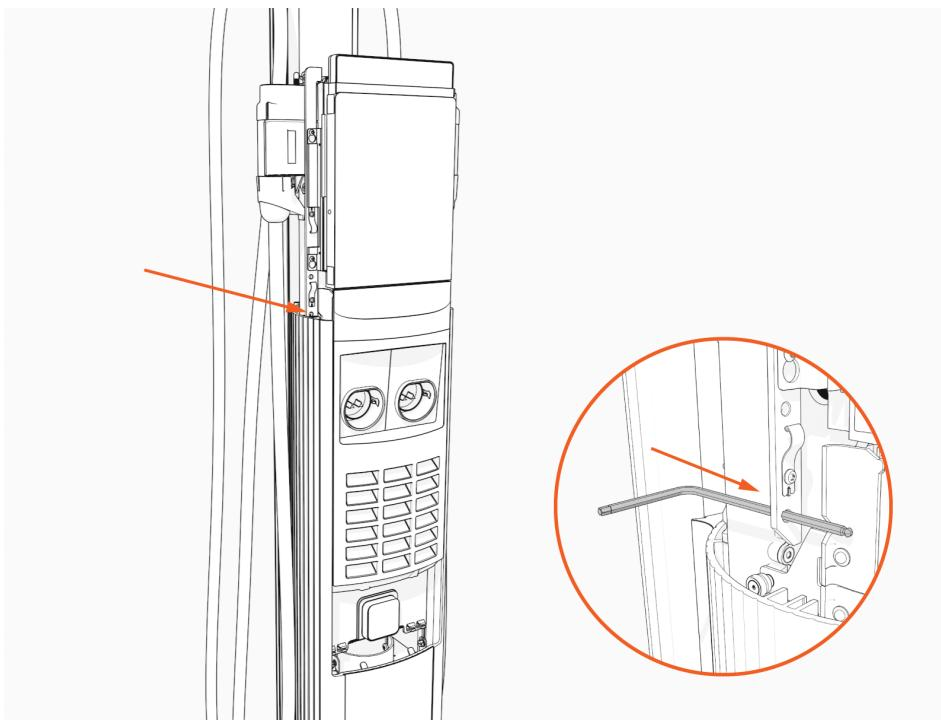
8. Lockern Sie mit Hilfe eines T25-Schraubendrehers die vier M4-Schrauben, mit denen die Steuer- und Kommunikationseinheit (CCOM) an der Kopfbaugruppe befestigt ist, entfernen Sie diese jedoch nicht.
