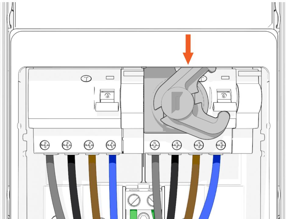
5. Wiederholen Sie die vorherigen Schritte, um den zweiten Reset-Schalter zu installieren. Installieren Sie den zweiten Schalter an Ladestationen mit einem und zwei Ausgängen.
