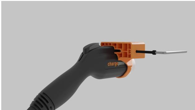
3. Verwenden Sie den Sechskantschlüssel, um die Antriebsschraube festzuziehen. Der Verriegelungsstift fährt langsam aus der Austrittsöffnung heraus. Sollten Sie zu viel Widerstand spüren, ohne dass sich der Stift bewegt, überprüfen Sie die Ausrichtung und versuchen Sie es erneut.
