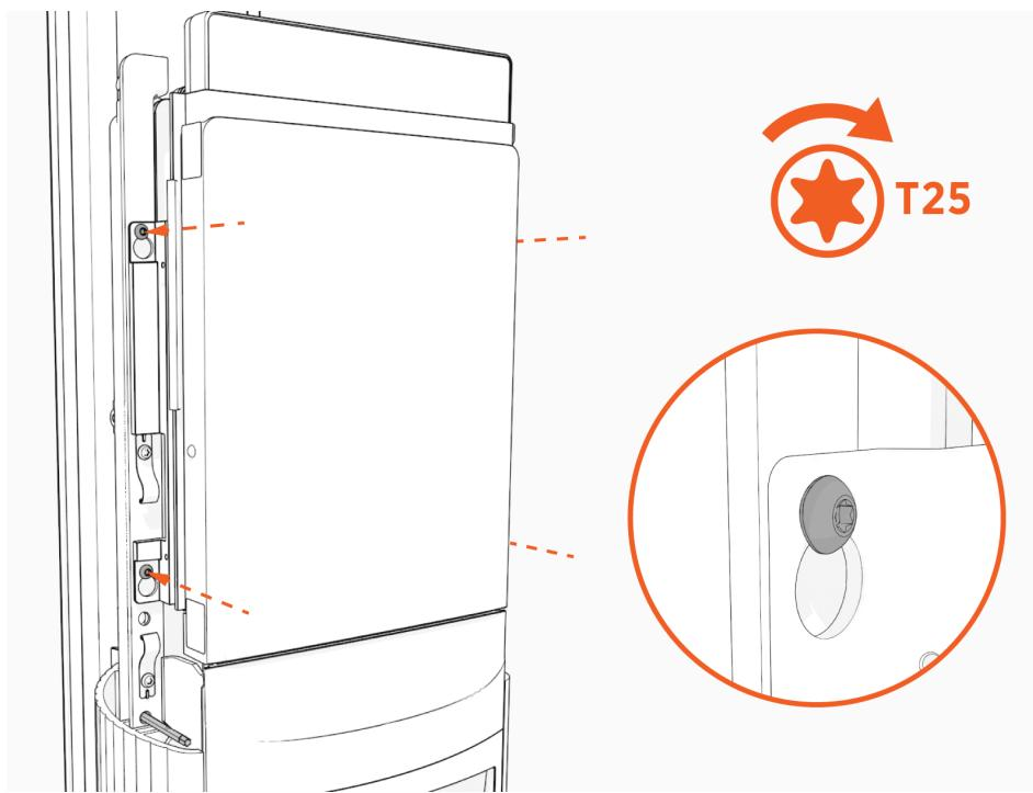
19. Heben Sie die Kopfbaugruppe an, um sie vom Gehäuse für die Sockel- oder Wandmontage zu entfernen. Legen Sie sie vorsichtig auf einer gepolsterten Fläche ab.
