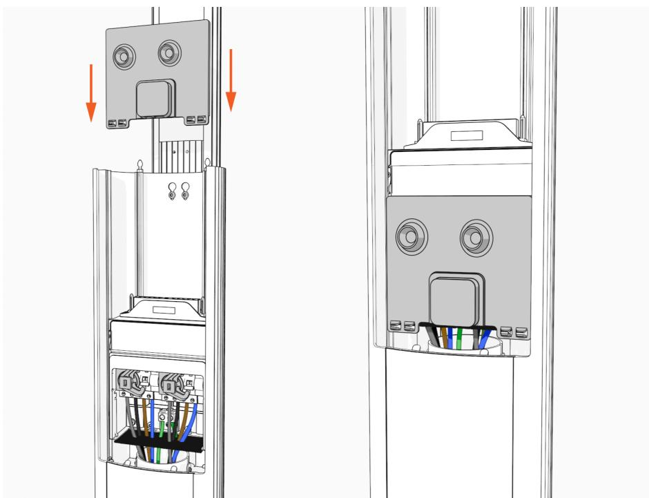
7. Richten Sie die Schienen der Kopfbaugruppe am Sockel aus, und schieben Sie sie teilweise in das Sockelgehäuse.
