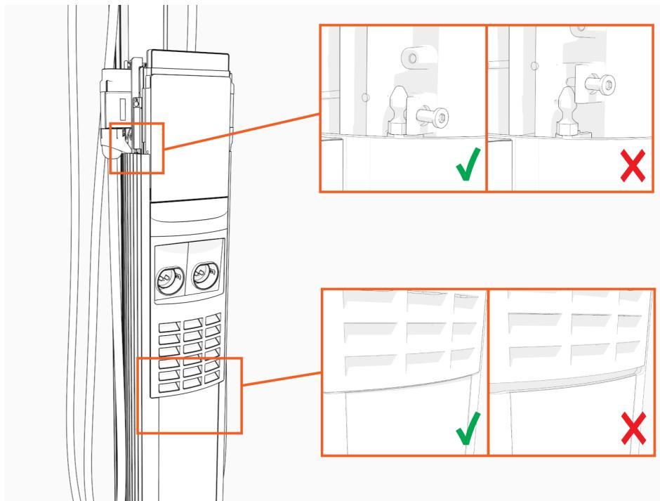
10. Ziehen Sie zwei Schrauben mit dem L-Schlüssel oder einem 4-mm-Inbusschlüssel fest.
