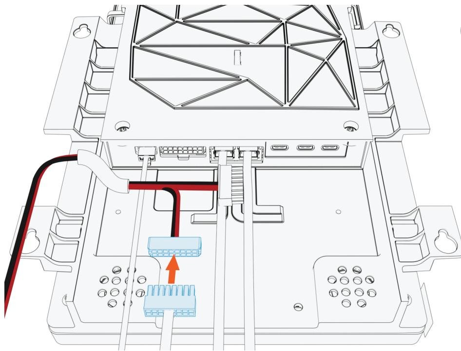
13. Stecken Sie den 16-poligen Stecker des Y-Split-Kabels an den Anschluss, aus dem Sie zuvor den 16-poligen Stecker des CCOM entfernt haben.
