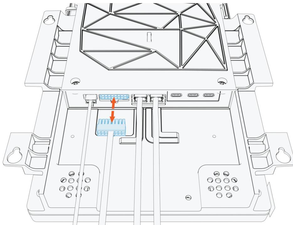
12. Stecken Sie den 16-poligen Stecker in die 16-polige Buchsenkomponente des Y-Split-CAN-Kabels.
