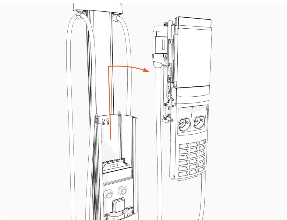
7. Schieben Sie die Abdeckung nach oben und entfernen Sie sie von der Stromversorgungsplatte.
