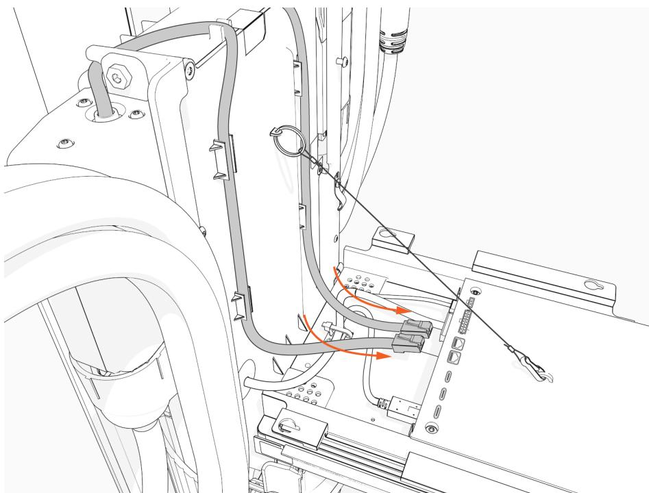
6. Stecken Sie die RJ45-Ethernetkabel in die Steckplätze.
