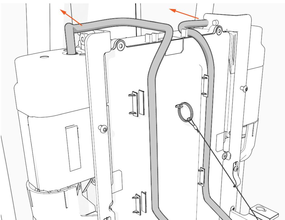
11. Trennen Sie die RJ45-Ethernet-Kabel vom CCOM.
