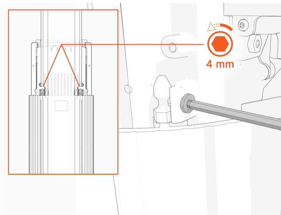
6. Heben Sie die Kopfbaugruppe an, um sie vom Gehäuse für die Sockel- oder Wandmontage zu entfernen. Platzieren Sie sie vorsichtig mit der Vorderseite nach unten auf einer gepolsterten Oberfläche.
