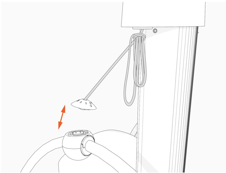
4. Drücken Sie mithilfe des mitgelieferten Werkzeugs das Knotenlager herunter und drehen Sie es ungefähr in einer 1/4-Drehung im Uhrzeigersinn, um die Kabelklemme anzuschließen.
