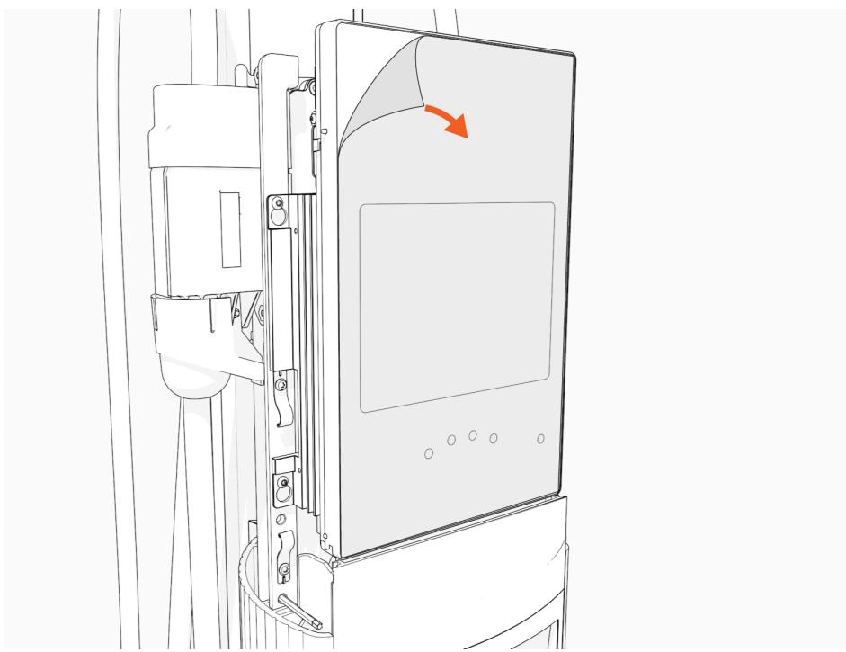
10. Befestigen Sie die Unter- und Oberkanten der vorderen Linse an der Kopfbaugruppe.
