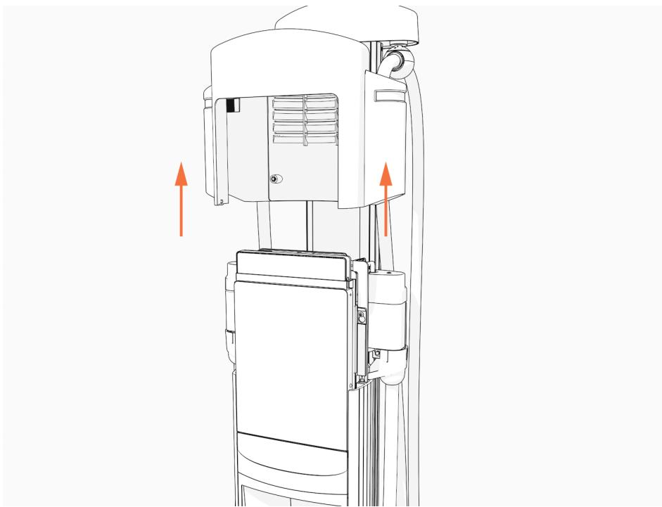
4. Verwenden Sie den L-Schlüssel, um die Schrauben zur Befestigung der Kopfbaugruppe zu lockern, aber nicht zu entfernen.
