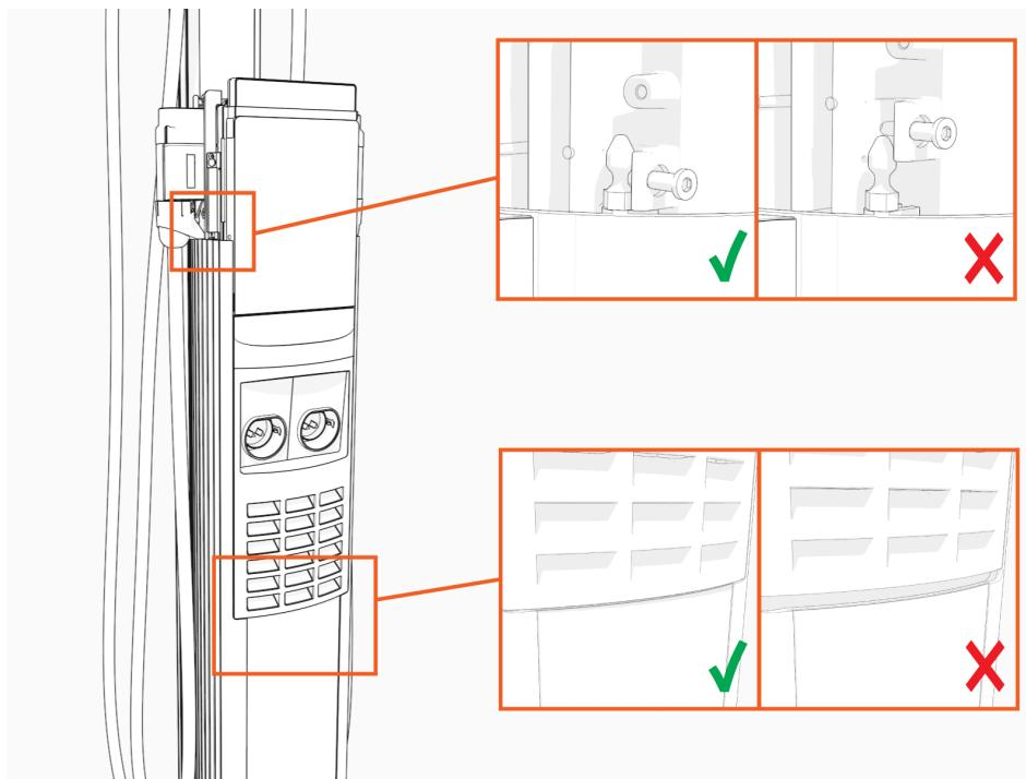
12. Ziehen Sie die zwei Schrauben mit dem L-Schlüssel fest.
