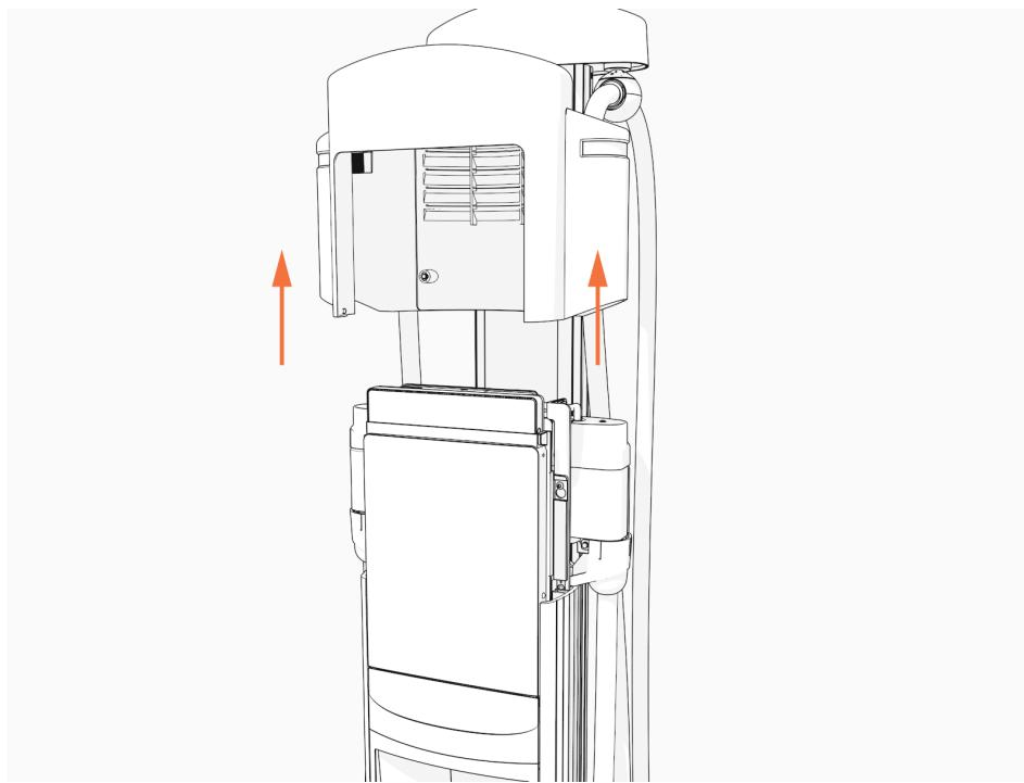
6. Verwenden Sie den L-Schlüssel, um die Schrauben zur Befestigung der Kopfbaugruppe zu lockern, aber nicht zu entfernen.
