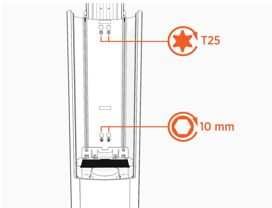
Ziehen Sie bei der Installation des neuen KMK die oberen T25-Schrauben mit **5,7 Nm (50 in-lb)** an. Verwenden Sie einen 10-mm-Schlüssel, um die Muttern in der Nähe des Bodens mit einem Drehmoment von **5,7 Nm (50 in-lb)** festzuziehen.
