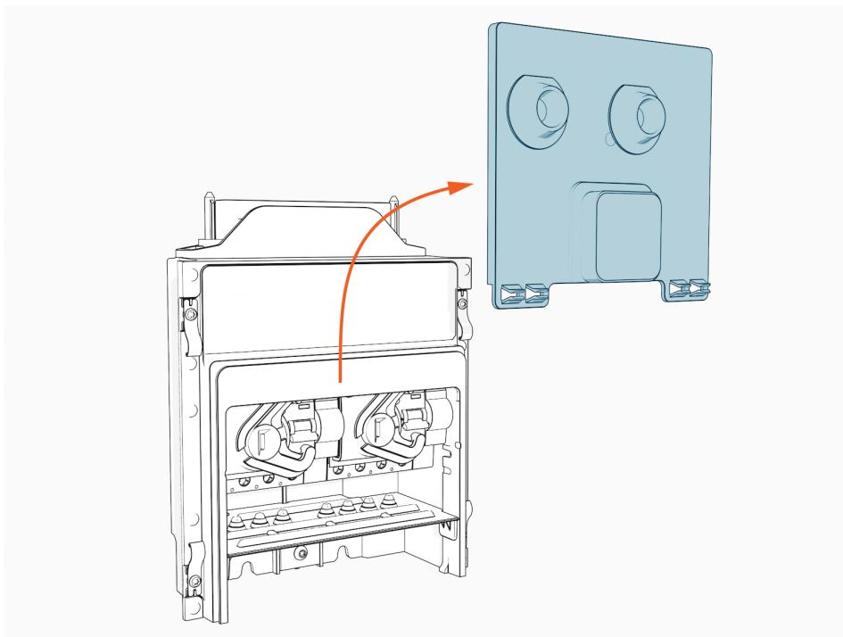
1. Montieren Sie die Steckbrücke. Dieser Schritt ist optional und nur bei Energieverteilung erforderlich.
