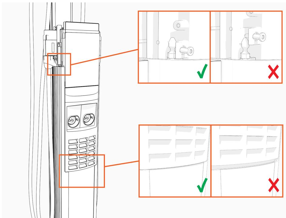
11. Ziehen Sie die beiden Schrauben mit dem L-Schlüssel von Hand an.
