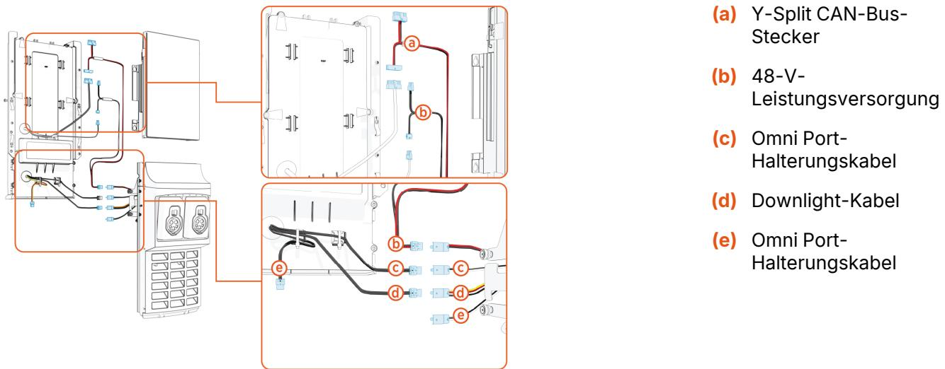
Wenn die CP6000 bereits mit einer Omni Port-Halterung installiert und konfiguriert wurde, befolgen Sie die Anweisungen in diesem Abschnitt, um die vorhandene Omni Port-Halterungsrahmenbaugruppe durch eine neue Omni Port-Halterungsrahmenbaugruppe zu ersetzen.
