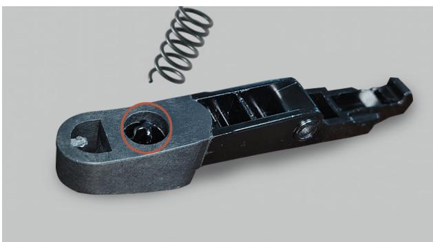
9. Allineare delicatamente l'altra estremità della molla con l'intaglio circolare nel connettore. Allineare i fori dei perni nel fermo e nel connettore.
