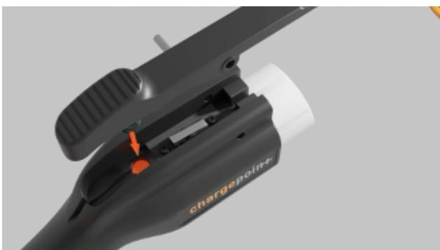
10. Inserire il perno di guida nel fermo per tenere insieme i pezzi. Serrare il fermo per assicurarsi che la molla funzioni correttamente.
