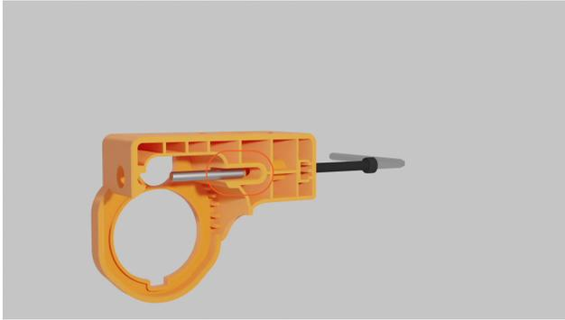
2. Insira o conector J1772 na ferramenta de reparação e empurre-o para o lugar até que o pino do trinco fique alinhado com o meio do orifício de saída.
