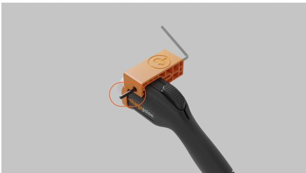
4. Aperte o parafuso de acionamento até que o pino do trinco se saia totalmente pelo orifício de saída. Retire-o à mão.
