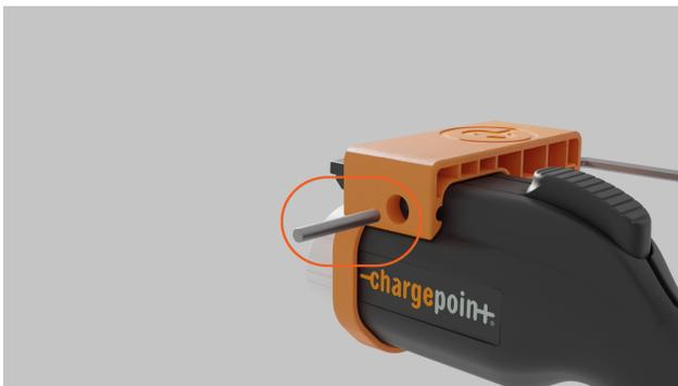
15. Solte o parafuso de acionamento 5-10 rotações e, em seguida, remova o conector da ferramenta.
