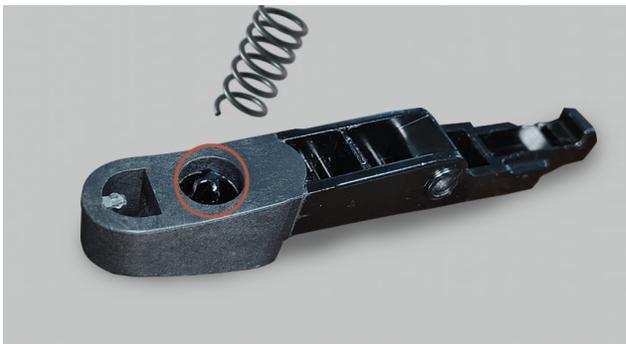
9. Alinhe suavemente a outra extremidade da mola com a reentrância circular no conector. Alinhe os orifícios dos pinos no trinco e no conector.
