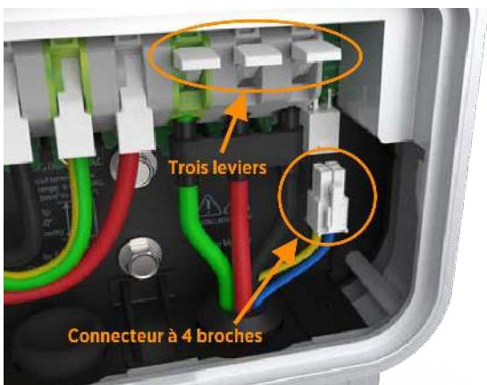
4. Insérez les autres fils dans les connecteurs correspondants sur le côté droit du bloc de jonction.
