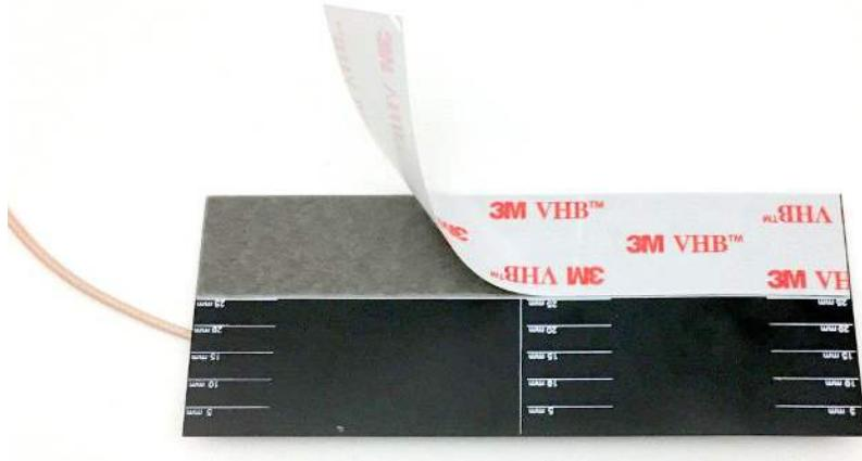
3. Poussez l'antenne (a) sur l'arrière du module de tête, comme illustré. Appuyez fermement sur l'antenne pour en assurer une bonne adhésion.
