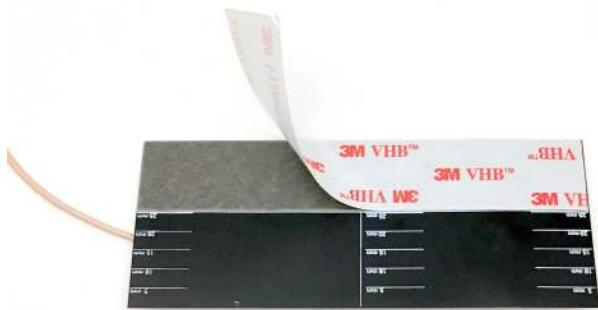
3. Poussez l'antenne sur l'arrière du module de tête, comme illustré. Appuyez fermement sur l'antenne pour en assurer une bonne adhésion.
