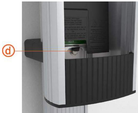
7. Débranchez le connecteur bleu en appuyant sur les languettes latérales tout en remuant le connecteur de gauche à droite et en tirant vers le bas.
