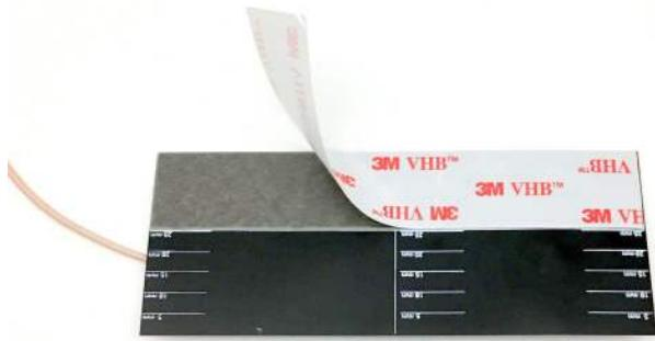
3. Poussez les antennes (a) sur l'arrière du module de tête, comme illustré. Appuyez fermement sur l'antenne pour en assurer une bonne adhésion.
