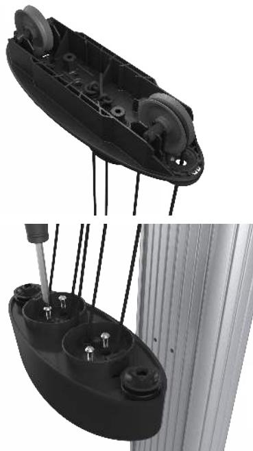
13. Vuelve a colocar la tapa superior con los cuatro tornillos.
