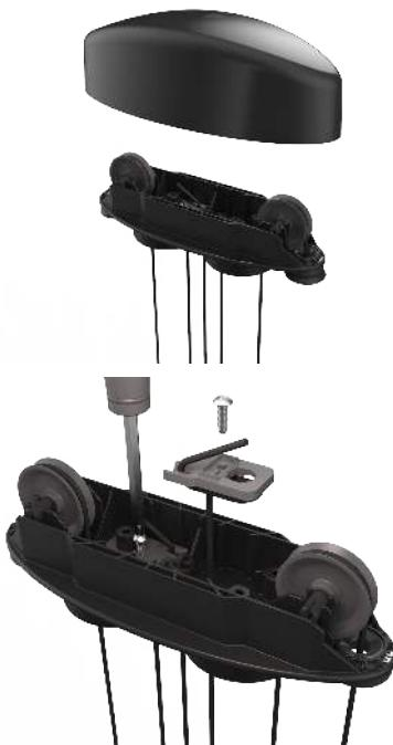
9. Quita los tornillos utilizados para sujetar la abrazadera y retira la pinza primero en un lado y después en otro.
