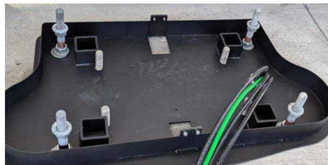
4. Faites passer les trois conducteurs c.a. et le câble de terre, d'une taille maximale de 35 mm<sup>2</sup> (2 AWG), dans le chemin de câbles de l'adaptateur.
