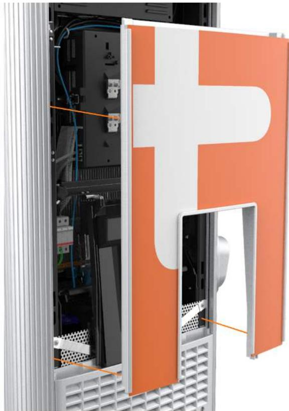
**Remarque :** Lors de la réinstallation, poussez le bord inférieur vers l'intérieur de manière à le positionner à l'intérieur de la rainure dans le panneau de ventilation central, puis enclenchez le bord de l'affiche. Poussez doucement le panneau vers le bas jusqu'à ce qu'il soit fermement en place.
