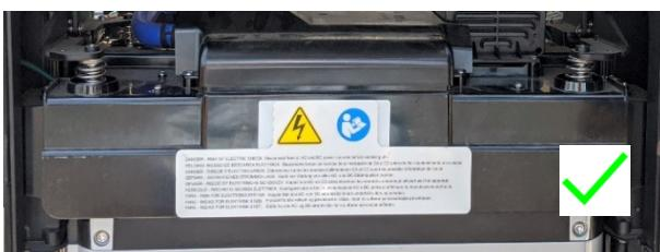
12. Le réservoir de liquide de refroidissement est plein et l'installateur a effectué un test de poussée/traction sur les deux raccords rapides :
