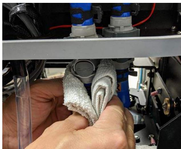
7. Branchez une extrémité de la conduite de purge sur le raccord rapide situé sous l'étagère et l'autre sur la conduite que vous venez de débrancher. La conduite de purge est dotée d'un connecteur mâle et d'un connecteur femelle, et ne se branche donc que dans un seul sens
