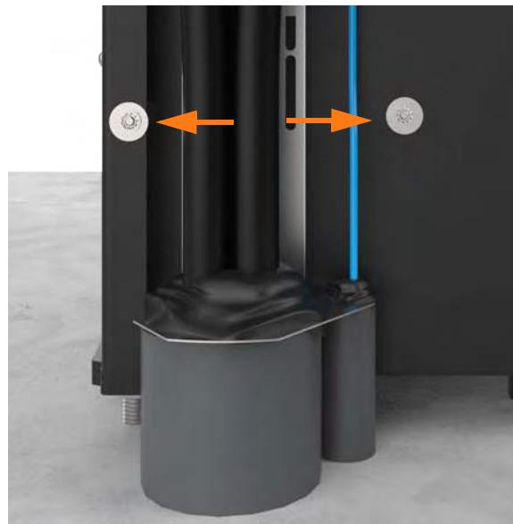
7. Inclinez légèrement le bas de l'extrusion vers l'extérieur pour dégager le bord supérieur du dessous du bord inférieur de la barre lumineuse de la zone. Soulevez l'extrusion pour la dégager des axes de guidage (de chaque côté du châssis) qui maintiennent l'extrusion en place.
