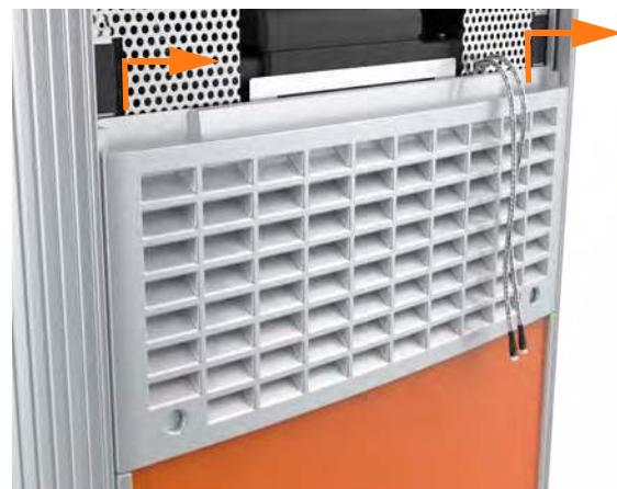
10. Retirez le panneau avant inférieur en le soulevant vers le haut du bas du panneau pour libérer les pattes de guidage de leurs fentes correspondantes sur le châssis de la borne Express 250.
