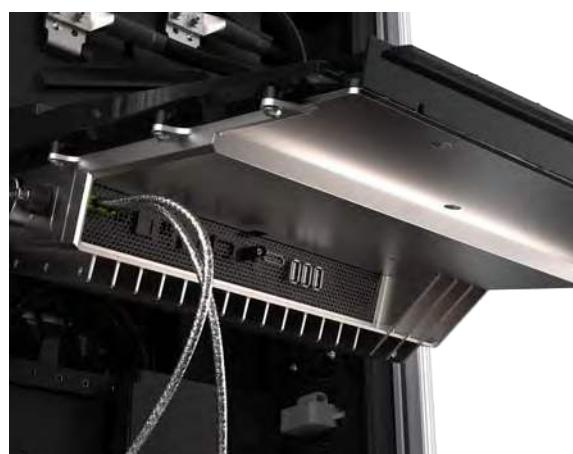
9. En utilisant les deux mains, une de chaque côté du panneau d'aération central, retirez le panneau en le tirant fermement vers le haut pour libérer les languettes de guidage des fentes correspondantes sur le châssis de la borne Express 250.
