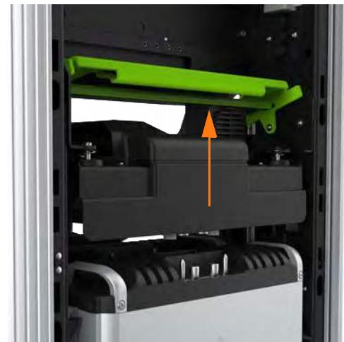
3. Le cas échéant, utilisez un tournevis Torx T25 pour retirer les rondelles et vis M5 avant et arrière fixant le support du module d'alimentation (a) et les tresses de masse du module d'alimentation (b) au châssis de la borne Express 250 (huit vis au total). Conservez les vis et les rondelles pour une utilisation ultérieure.
