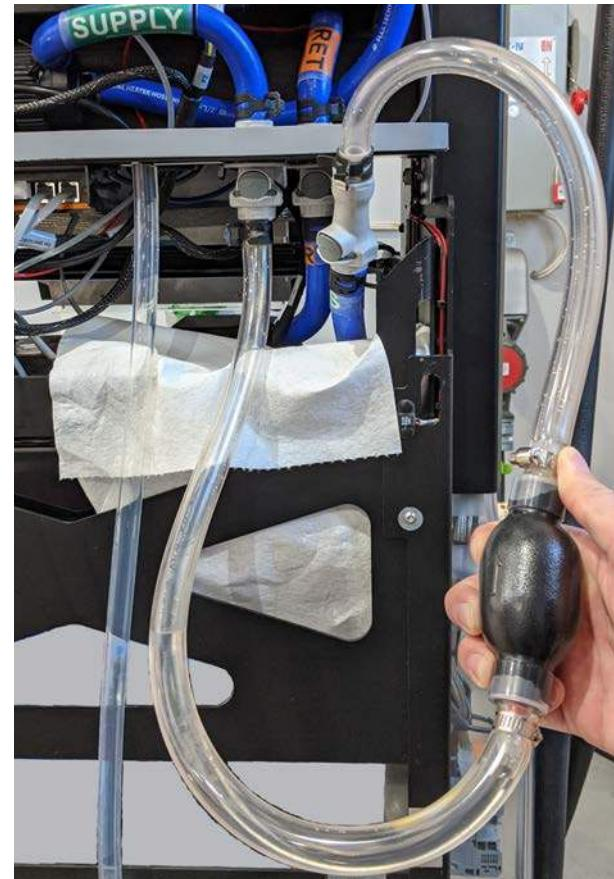
12. Befestigen Sie die hinterste Kühlmittelleitung mit einem Kabelbinder an der Rücklauf-Kühlmittelleitung (j), um ihren Winkel zu erhöhen und zu verhindern, dass sich Luft in der Leitung ansammelt.
