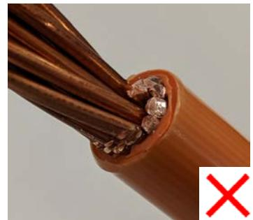
8. Rimuovere il sigillante del condotto per verificare che il materiale isolante del conduttore non sia danneggiato.
