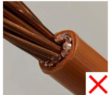
8. Retira la junta del conducto para comprobar que el aislamiento del conductor no ha resultado dañado.
