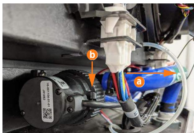
2. Usa un destornillador Phillips n.<sup>o</sup> 1 con adaptador de ángulo recto para aflojar el tornillo de la abrazadera (b) hasta que puedas girar la bomba.
