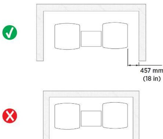
Si l'entrée de conduit en surface est utilisée, les dégagements latéraux doivent également permettre la flexion et la traction du câble en surface.
