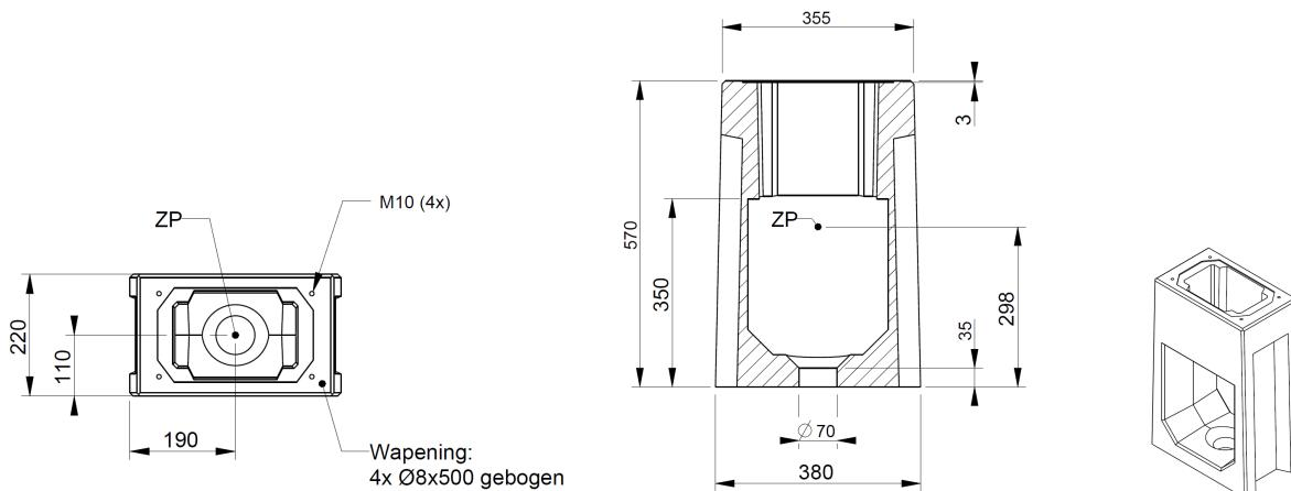
Dimensions de la dalle (longueur x largeur x profondeur) : 380 x 220 x 570 mm
