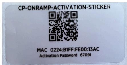
Inserire: **0224B1FFE0013AC** nella configurazione della stazione di ricarica invece di **0224:B1FF:FE00:13AC**
