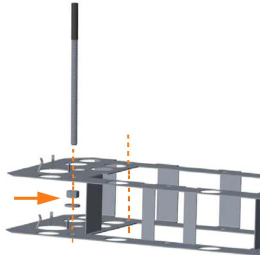
4. Halten Sie die untere Mutter und die Unterlegscheibe bündig an der Oberseite der Bodenplatte, und schrauben Sie den Bolzen auf die Mutter, bis der Abstand zwischen der Unterseite der Kunststoffkappe und der Oberfläche der oberen Platte 51 mm (2 Zoll) beträgt.
