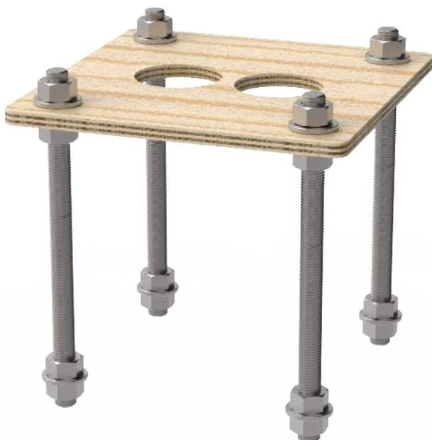
10. Sur l'extrémité inférieure de chaque boulon, installez un écrou, une rondelle et un écrou. Serrez les écrous ensemble en alignant l'écrou du dessous avec le bas du boulon. Cette mesure assure la retenue du boulon dans le béton.
