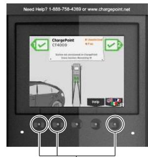
Si l'assistant d'installation ne s'affiche pas lors de la mise sous tension, appuyez simultanément sur ces trois boutons et maintenez-les enfoncés pendant deux secondes afin d'afficher le menu de service sur une borne non activée.
