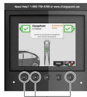
Si l'assistant d'installation ne s'affiche pas lors de la mise sous tension, appuyez simultanément sur ces trois boutons et maintenez-les enfoncés pendant deux secondes afin d'afficher le menu de service sur une borne non activée.
