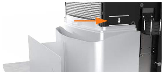
8. Utilisez un tournevis Torx T25 pour fixer la base du boîtier à la borne, en serrant 4 vis de chaque côté (8 au total, incluses dans le kit SCE). Serrez à un couple de 4 Nm.
